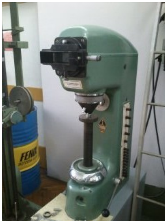
Slika 3.2.5: Uređaj za merenje tvrdoće po Vickersu
