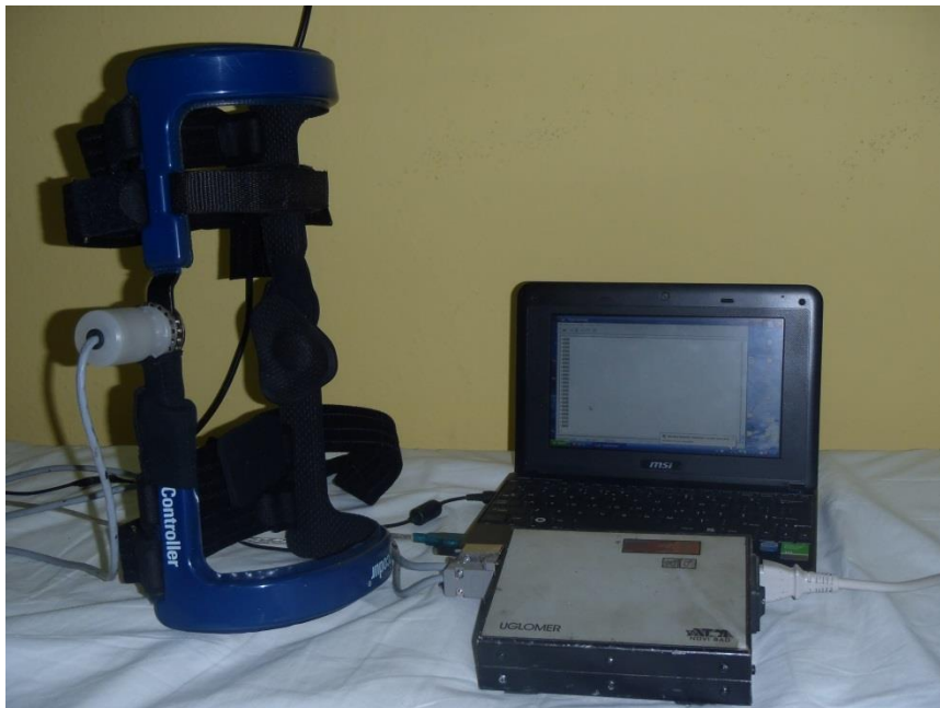
Slika br.14. Digitalni goniometar
