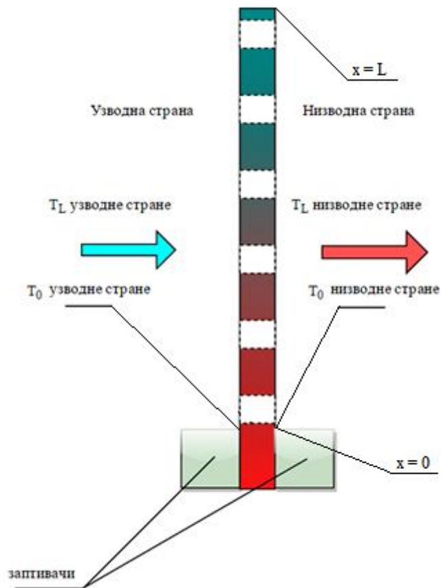
Слика 5.1 Карактеристичне температуре перфориране плоче
