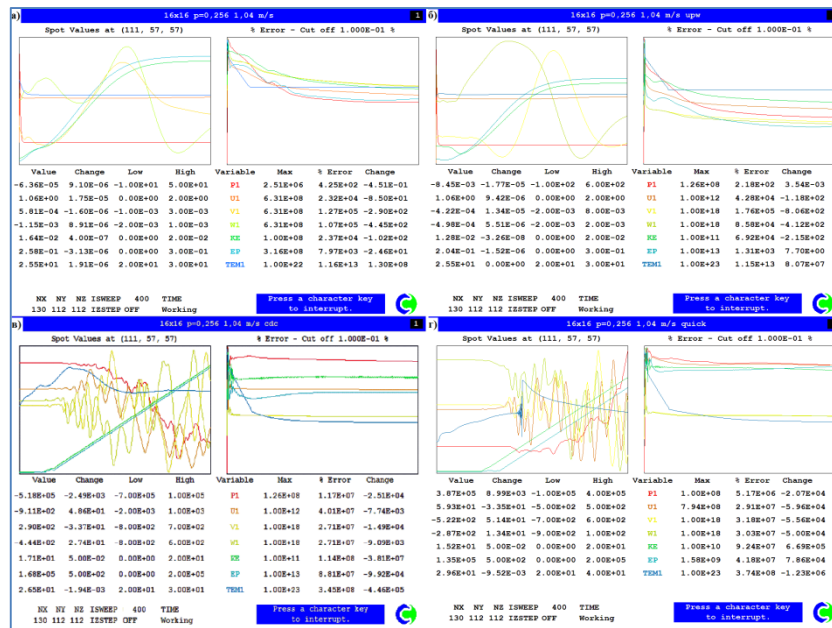
Слика 4.12 Остварене конвергенције за а) HDS, б) UDS, в) CDS и г) QUICK
