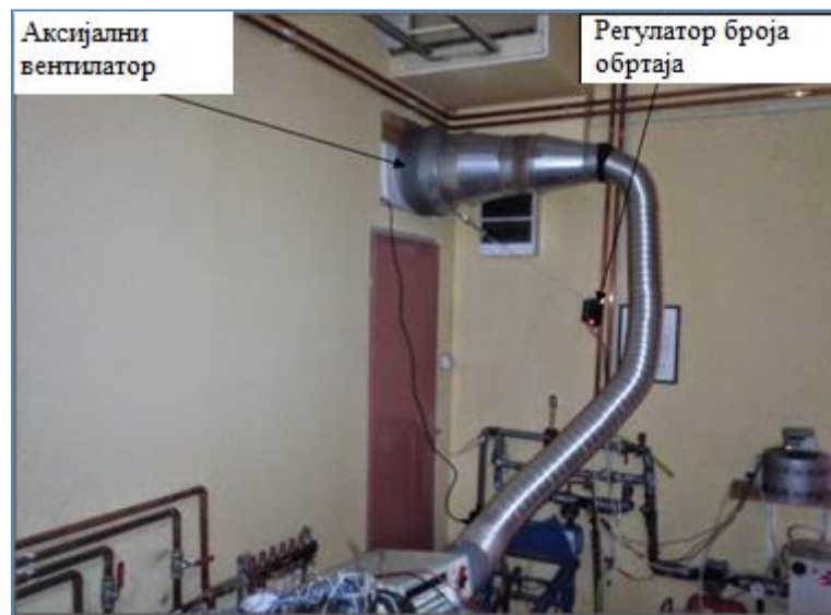
Слика 3.8 Постављање вентилатора
