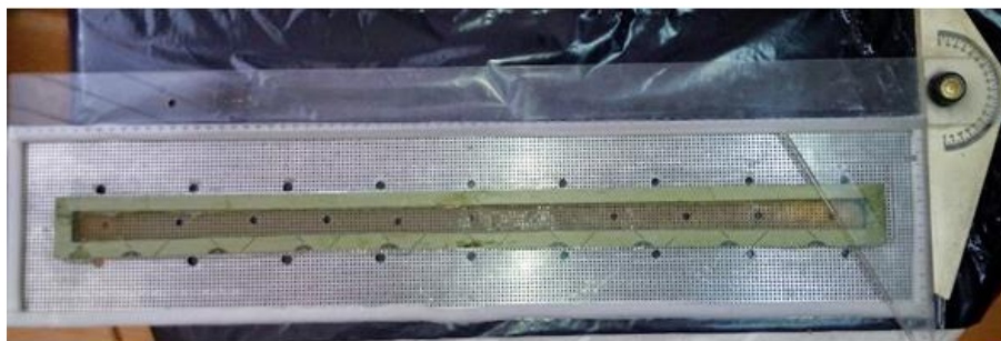
Слика 3.2 Изглед испитиване плоче са заптивкама
