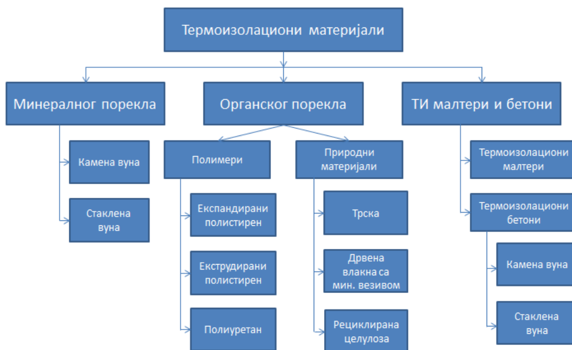
Слика 3.2. Подела термоизолационих материјала
