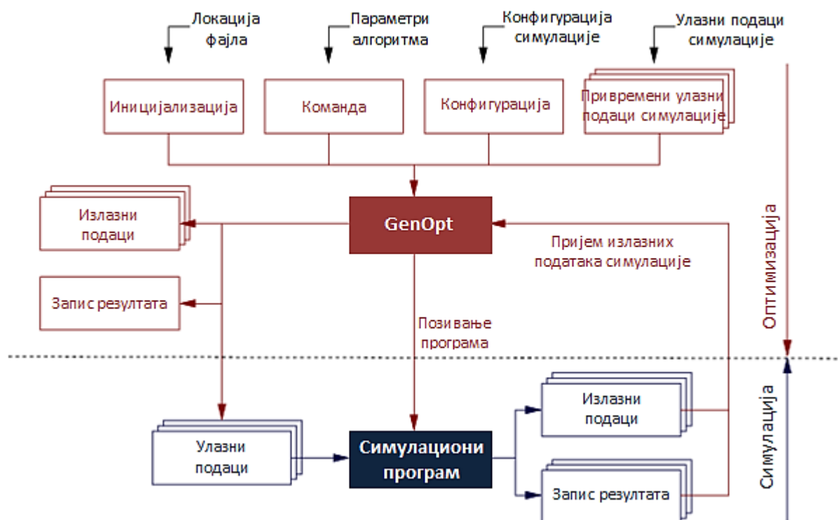
Слика 5.5. Начин повезивања и симулације коришћењем Genopt софтвера
