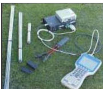
Slika 7. Uređaj za merenje vlage u supstratu – TDR.
