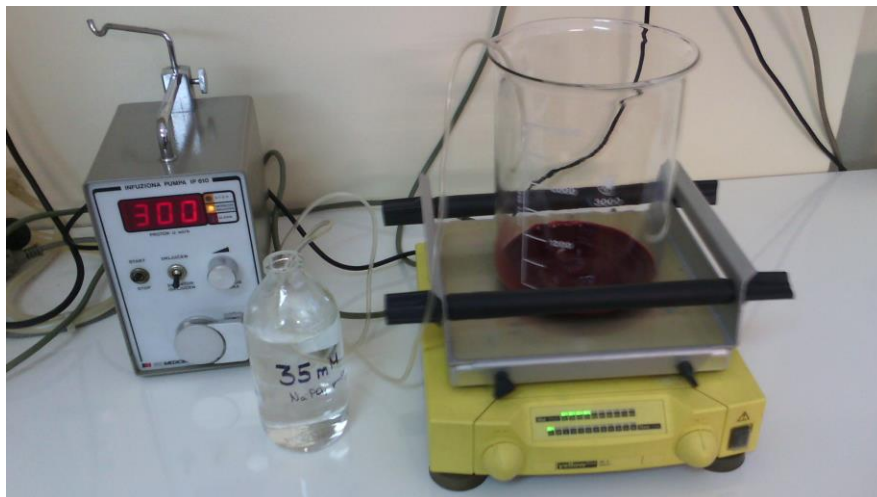
Слика 23. Апаратура за извођење градуалне хипотоничне хемолизе
