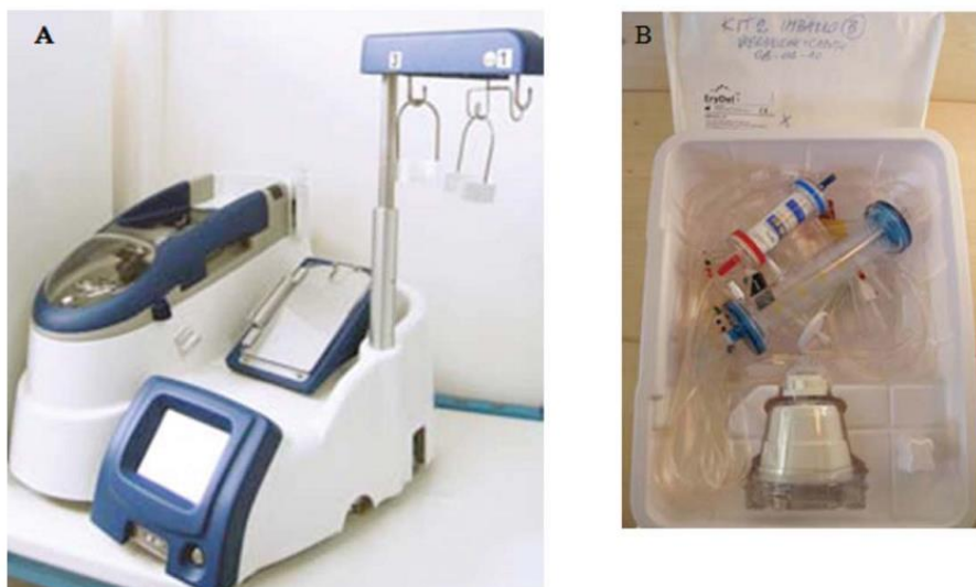
Слика 13. Тренутна медицинска опрема са „СЕ“ ознаком којом се врши инкапсулација лекова у аутологе еритроците на репродукцибилан и поуздан начин у компанију EryDel S.p.A. А) уређај "Red Cell Loader", Б) стерилни и апиروجени комплет материјала за једнократну употребу [52]
