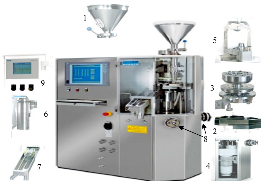
Slika 1.4 Osnovne komponente i podsistemi rotacione tablet-prese (Korsch, 2010)
