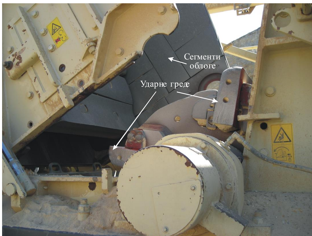
Слика 9.6.20 Унутрашњи изглед ротационе дробилице са ударним гредама капацитета 350 \text{ m}^3/\text{h}
