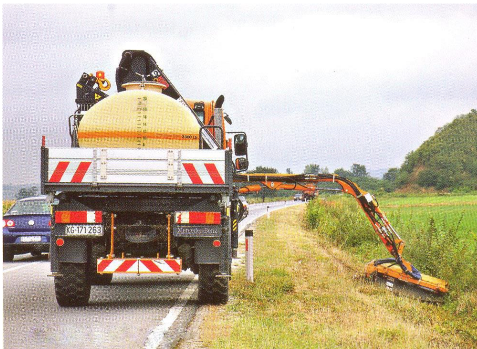
Слика 9.6.27 Изглед радне машине типа UNIMAG-640 за време рада
