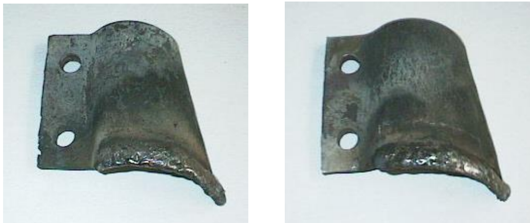
Слика 9.6.38 Изглед репаратурно наварених ножева уређаја за ископ канала
