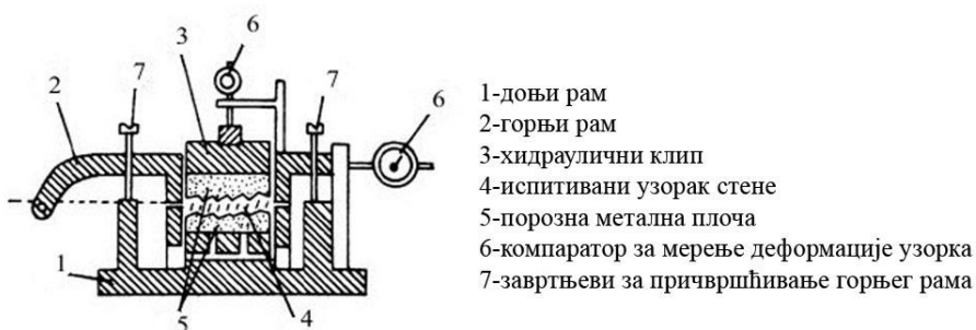
Слика 9.1.20 Схема Касаграндеовог уређаја за извођење опита директног смицања [56,190]
