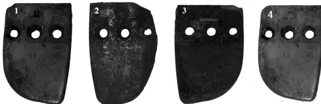
Слика 9.6.17 Изглед радних површина лопатица после 720 h рада: 1-навар од D.M.-E DUR 600; 2,3-навар од D.M.-ABRADUR 58; 4-навар од D.M.-CrWC 600
