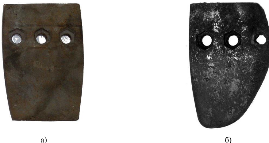
Слика 9.6.14 Изглед лопатица мешалице: а) нова лопатица, б) похабана лопатица
