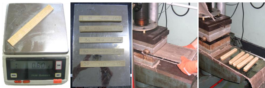
Slika 4.24. Nanošenje adheziva, slaganje sendviča na podložni lim i vrelo presovanje
