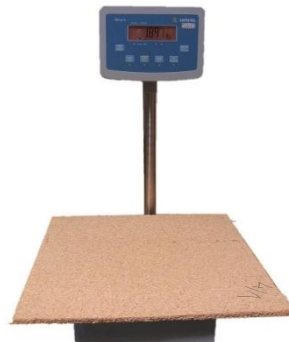
Slika V-23. Merenje mase gotove ploče
