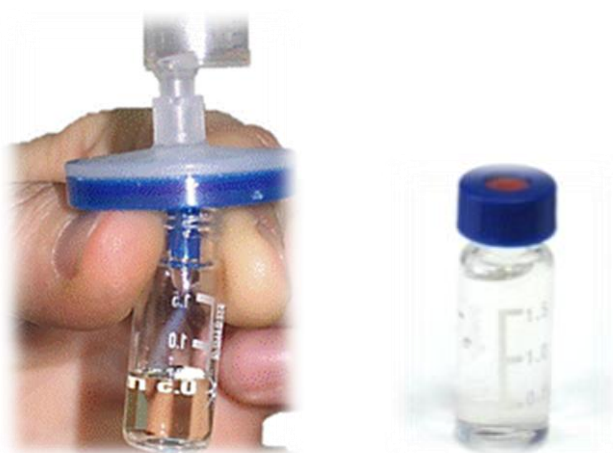
Slika 4.31. Priprema uzoraka: filtriranje i uzorak pripremljen za HPLC analizu
