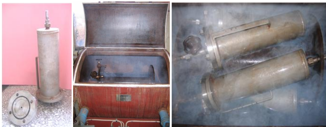
Slika 4.20. Autoklav i uređaj "Stalsvets" sa autoklavima
