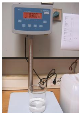
Slika V-3. Priprema rastvora katalizatora
