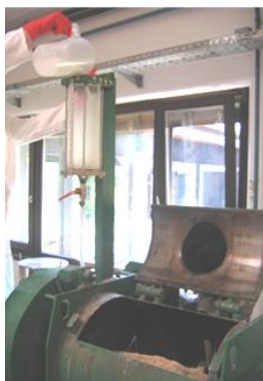
Slika V-6. Punjenje menzure uređaja za oblepljivanja adhezivom
