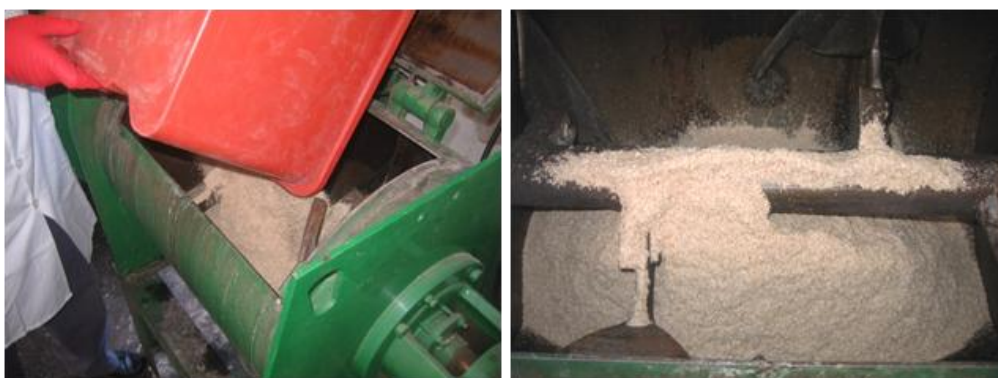
Slika V-7. Sipanje iverja u oblepljivačicu
