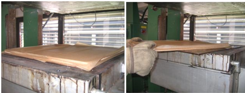
Slika V-21. Otvaranje prese i vađenje ploče iz prese
