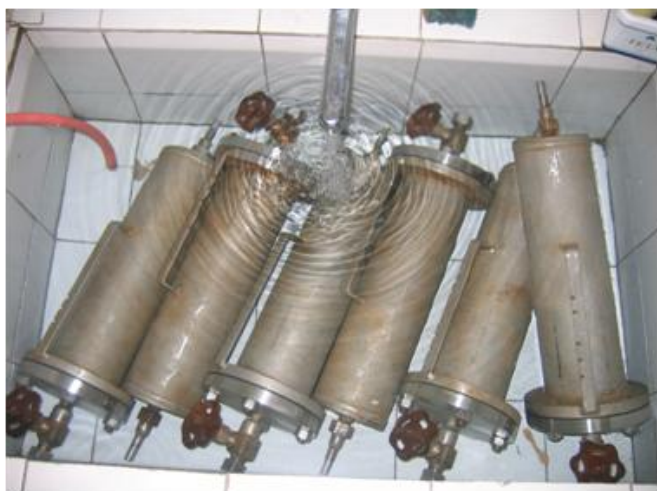
Slika 4.36. Hlađenje autoklava u vodenom kupatilu
