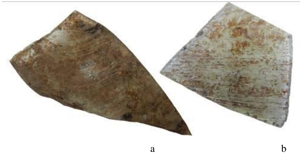
Sl. 35. Prozorsko staklo iz Medijane izrađeno u tehnici duvanja u cilindar 26
