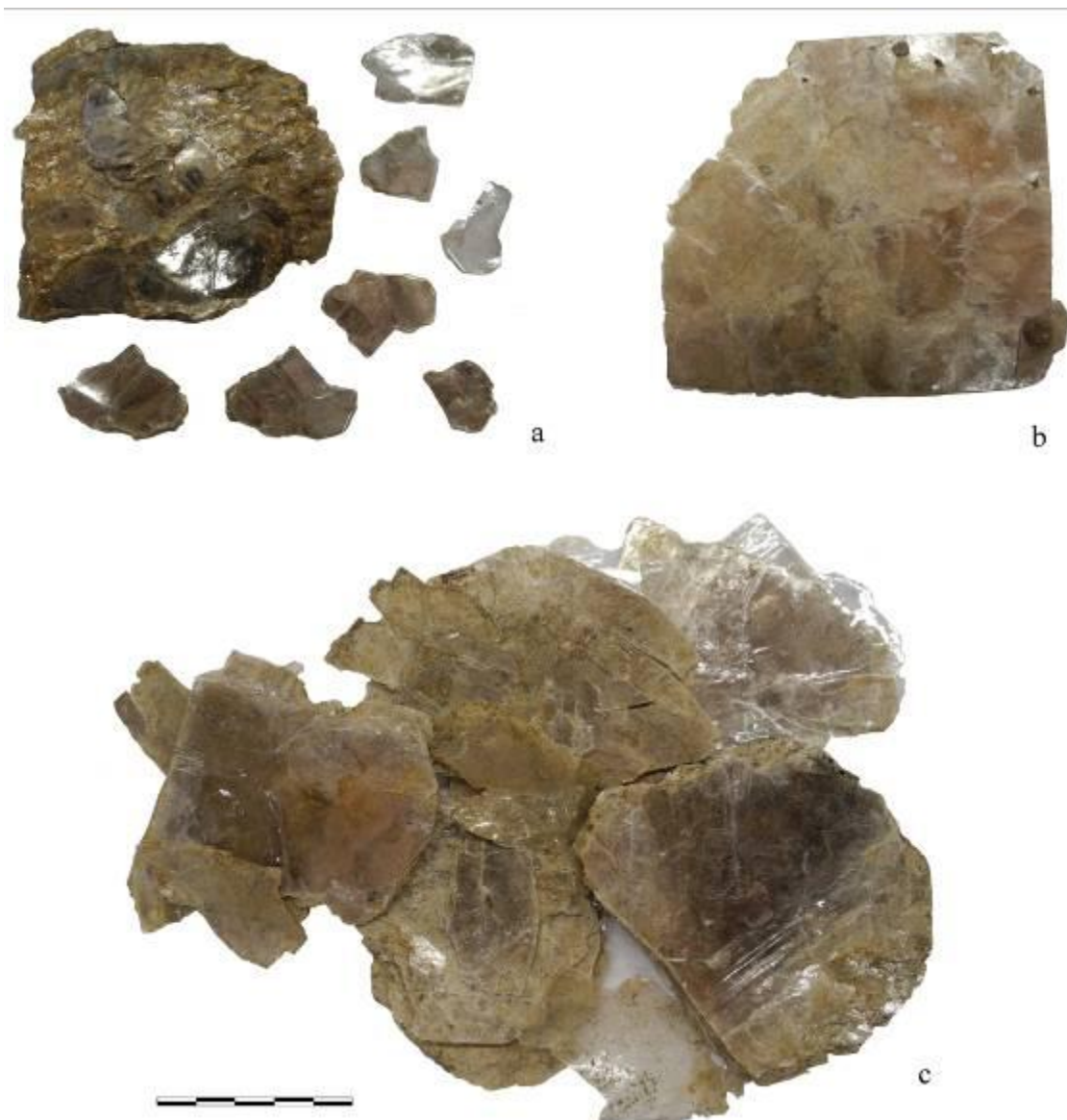
Sl. 77. Liskun: (a) sirovina, kamen; (b) fragment okna od liskuna sa očuvanim ivicama i nitnama (c) komadi liskuna
