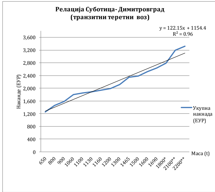
Слика 6.13. Графички приказ зависности масе транзитног теретног воза и висине накнаде (релација Суботица-Димитровград)
