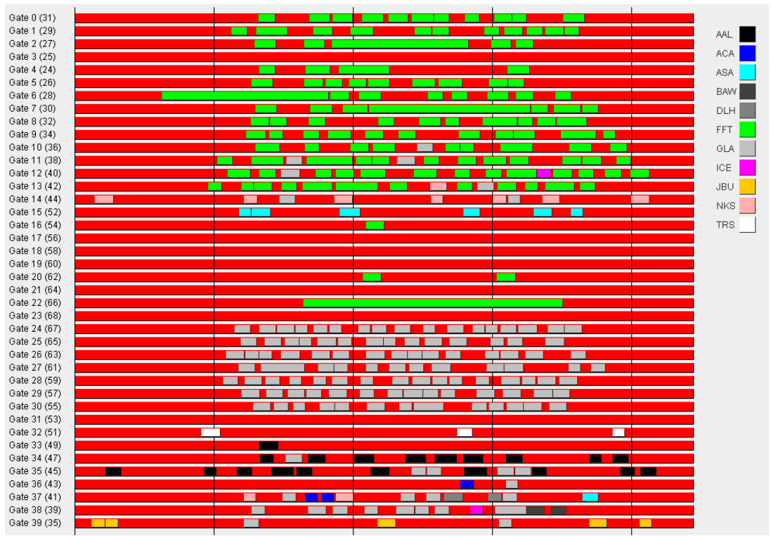
Слика 4.5. План додељивања паркинг позиција добијен ВСО алгоритмом
