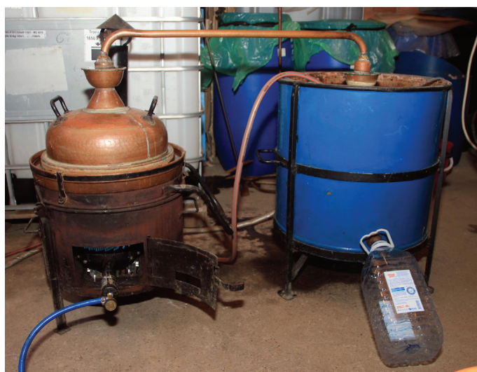
Fotografija 9. Destilacioni aparat zapremine 25 litara
