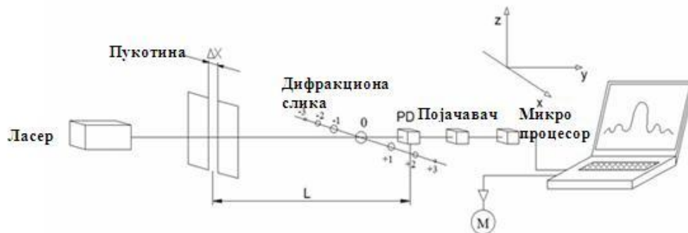
Слика 3.10 - Шема експерименталне поставке за приказ дифрактограма и мерење ширине централног максимума \Delta t помоћу ласерског снопа (PD-фото детектор, M-степ-мотор)
