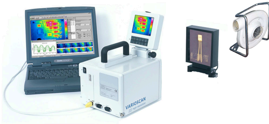
Slika 7.2: Prikaz termovizijskog mernog metoda sa kontrolisanim izvorom toplote.
