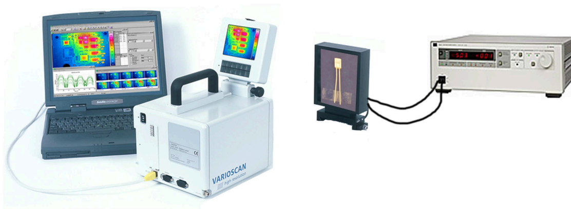
Slika 7.1: Prikaz termovizijskog mernog metoda sa kontrolisanom strujom.
