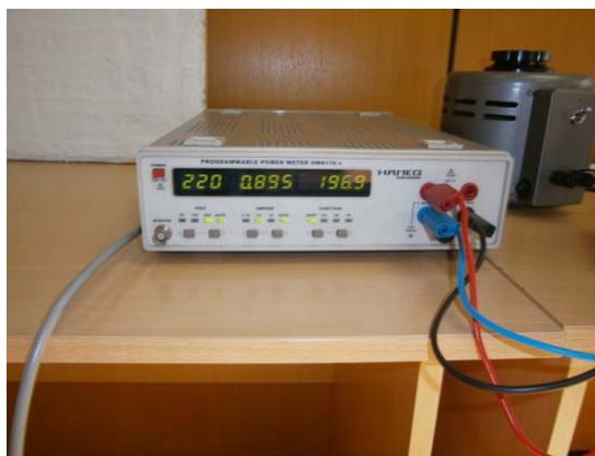
б) Излазне вредности из аутотрансформатора
