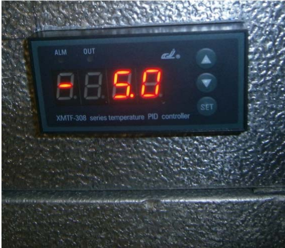
Слика 8.1 Сензор за одржавање температуре унутар тест коморе [46]
