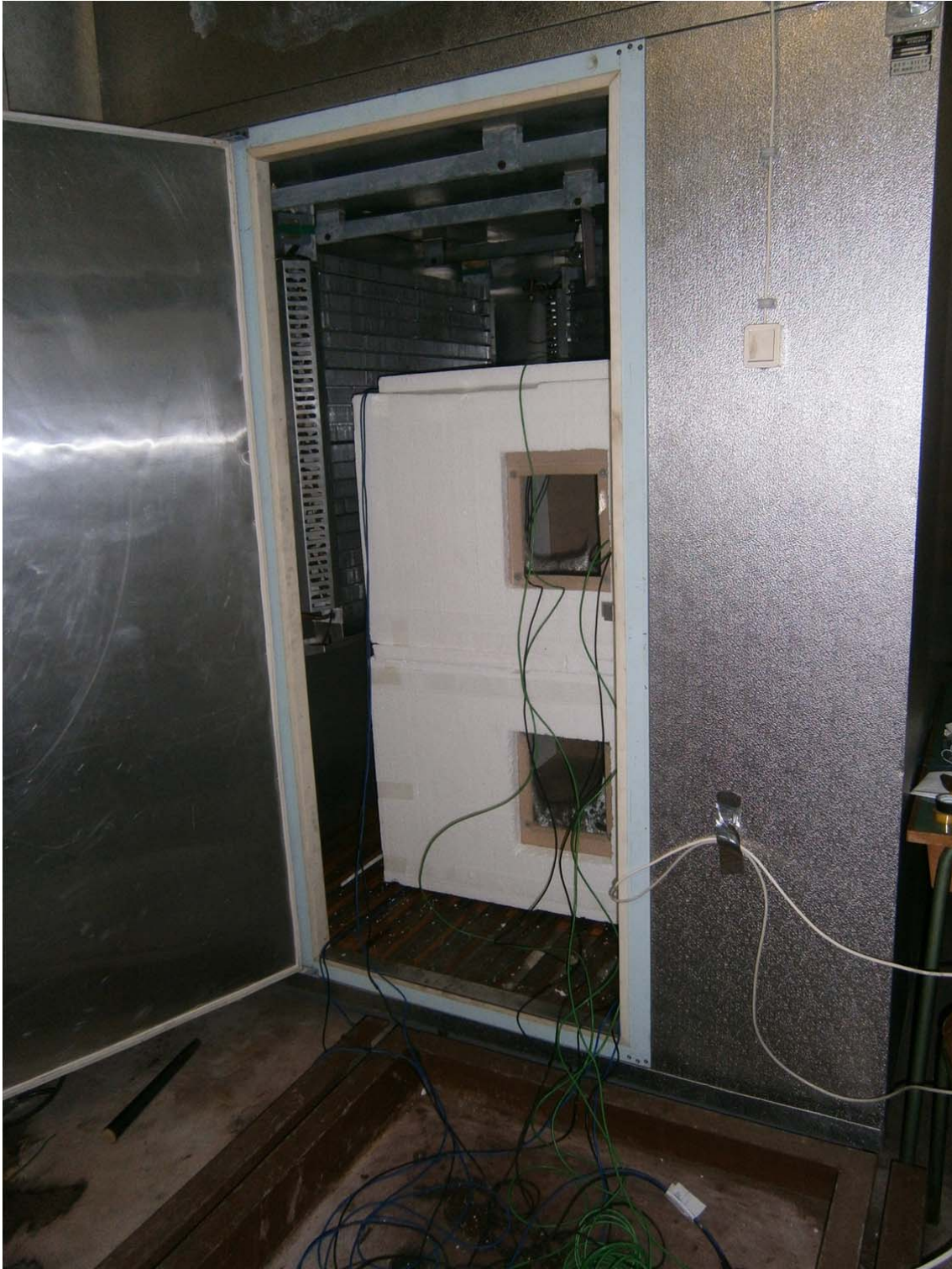
Слика 8.38 Тест модел са повезаним мерним елементима за мерење топлотног флукса
