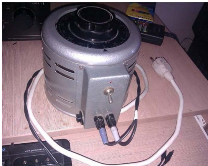
Слика 8.11 Аутотрансформатор “ISKRA TRN 110”
