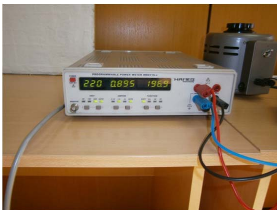
б) Излазне вредности из аутотрансформатора
