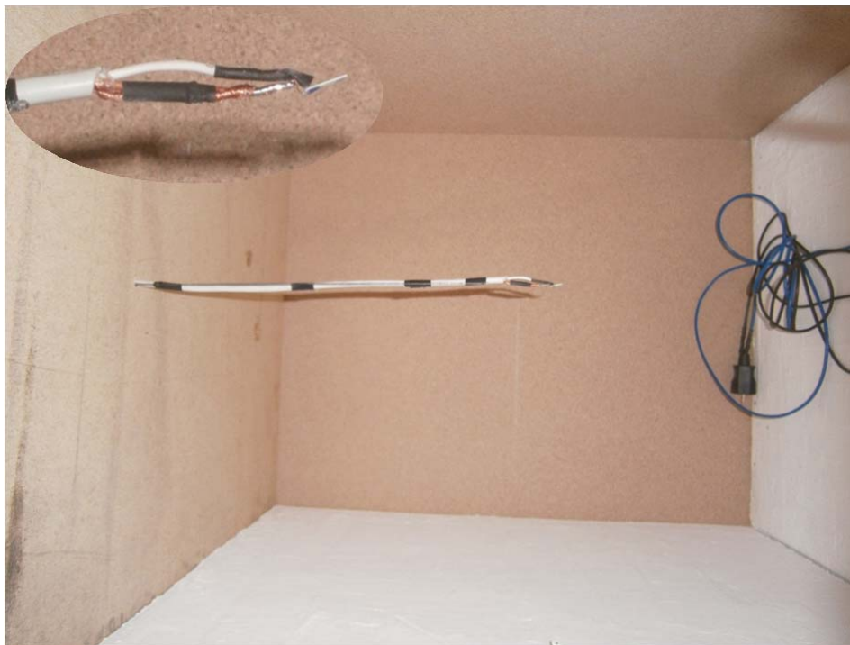
Слика 8.6 Унутрашњост просторије тест кућице – приказ положаја сонде ПТ100
