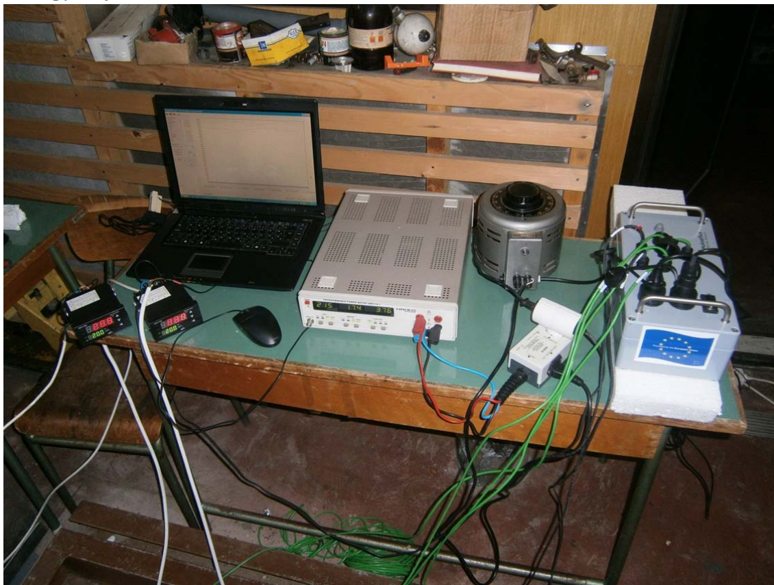
Слика 8.36 Мерна инсталација за мерење топлотног флукса
