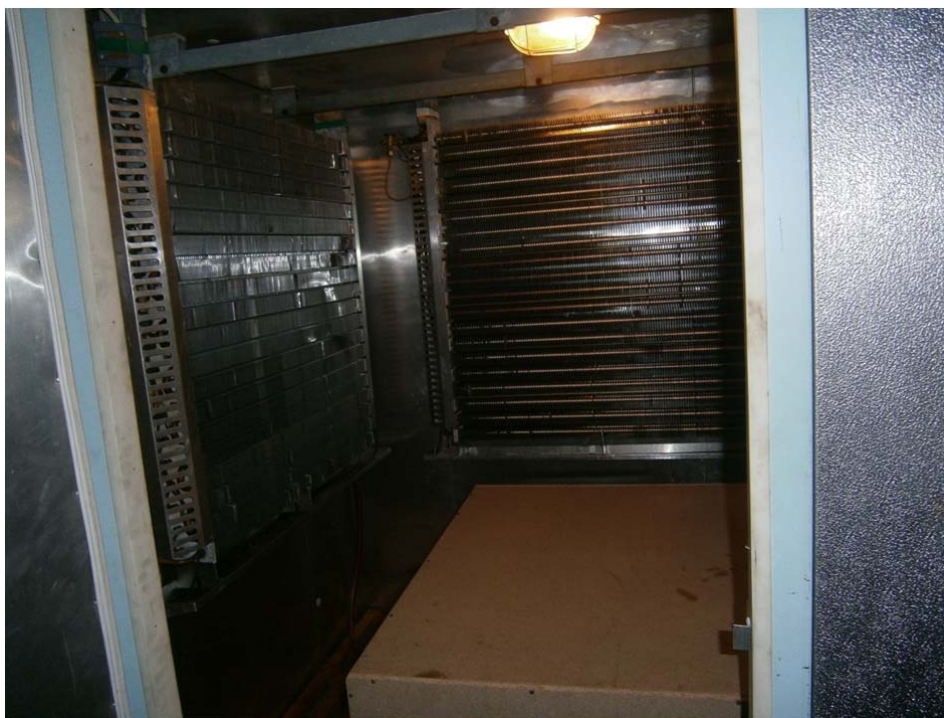
Слика 8.4 Унутрашњост тест коморе – приказ испаривача
