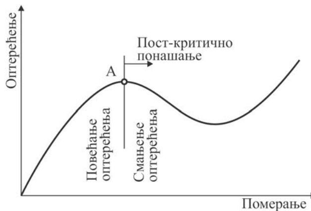
Слика 3.4 Пост-критично понашање конструкције
