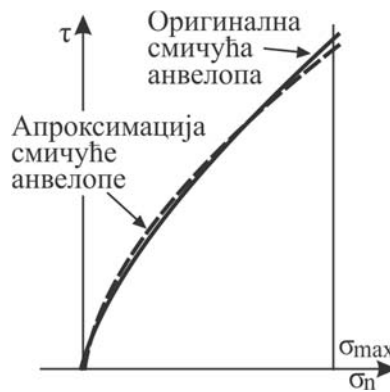
Слика 7.10 Редукована и апроксимирана анвелоба лома нелинеарних модела
