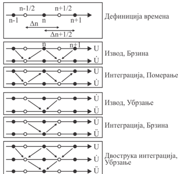
Слика 4.3 Шема израчунавања у методи централних разлика
