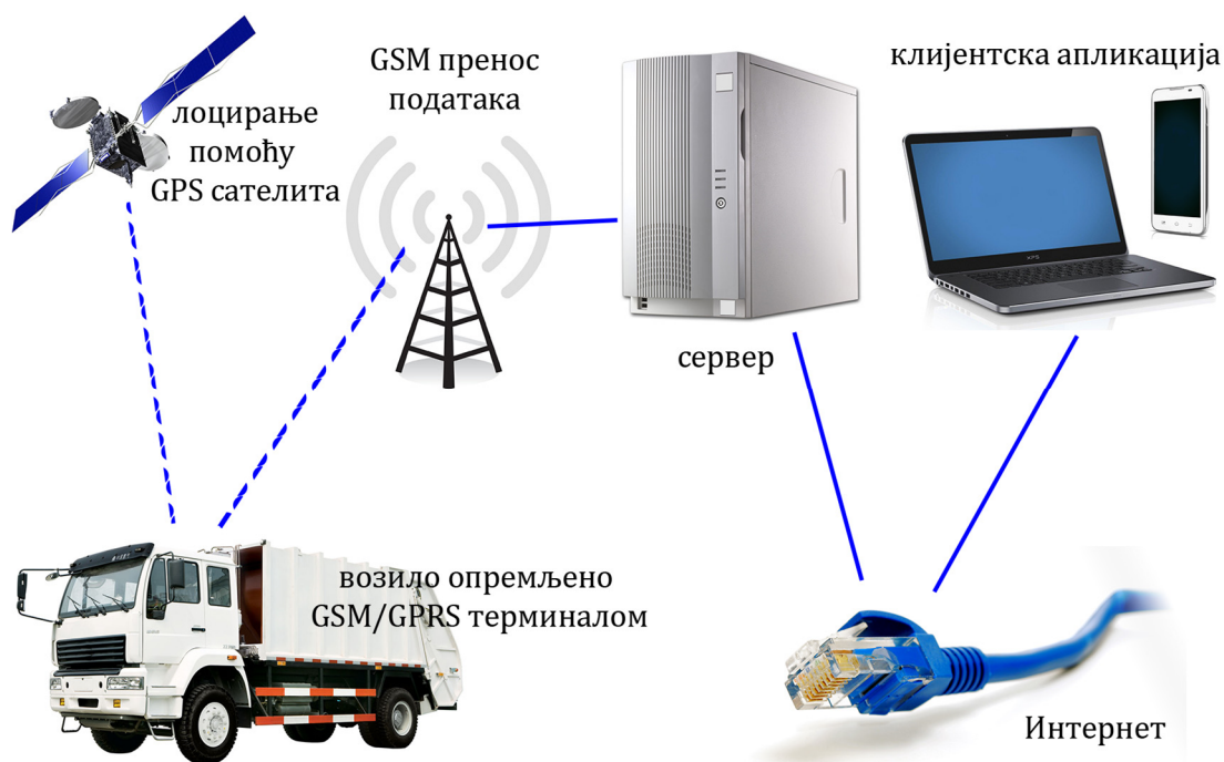
Слика 3.5 Шематски приказ система за мониторинг кретања возила
