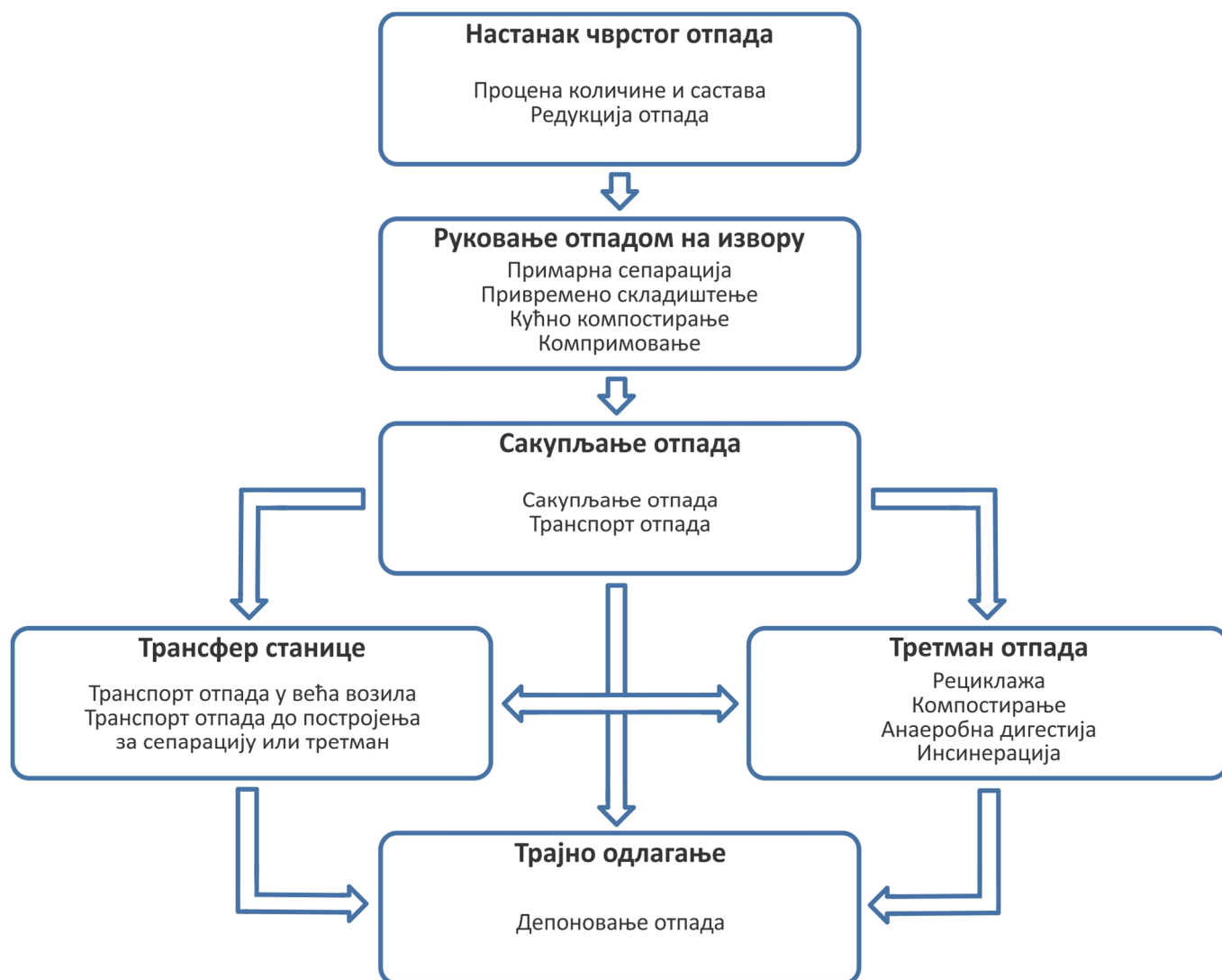
Слика 2.11 Веза елемената система за управљање отпадом
