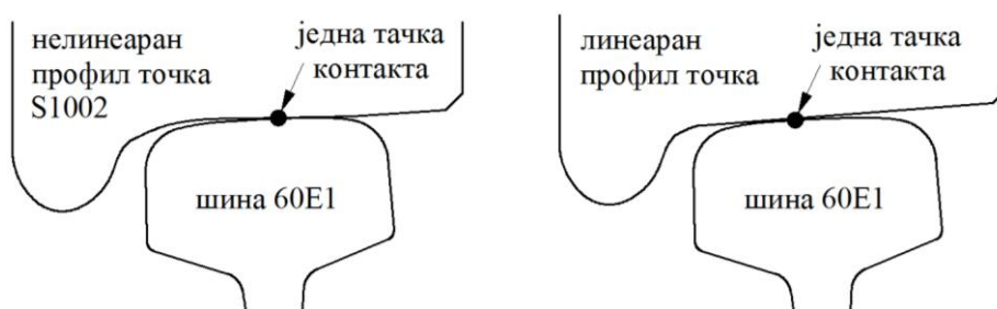
Слика 2.11. Контакт преко површине котрљања – једна тачка контакта
