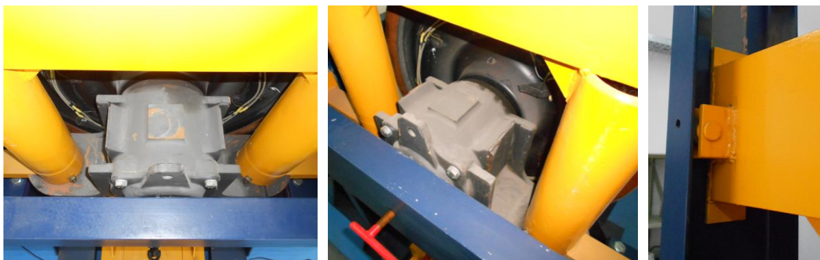
Слика 7.9. Начин ослањања горњег осовинског склопа (лево) и детаљ вођења вертикално покретног носача горњег осовинског склопа (десно)
