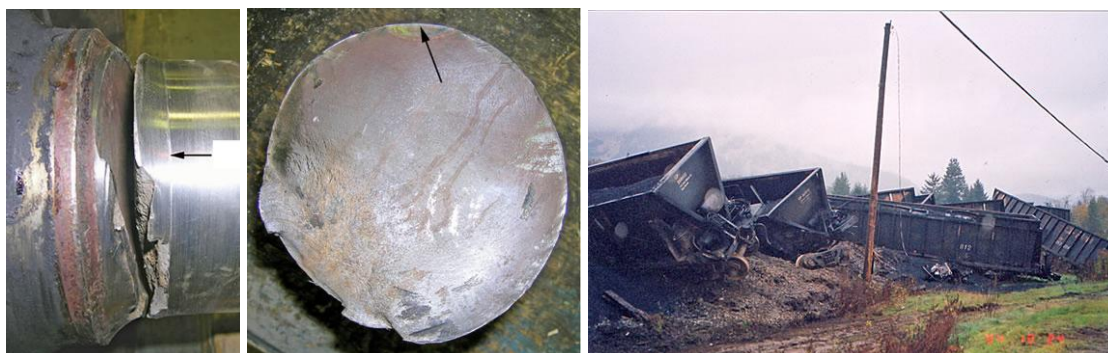
Слика 4.28. Исклизуће узроковано ломом осовине (Канада, 2004. године) [54]
