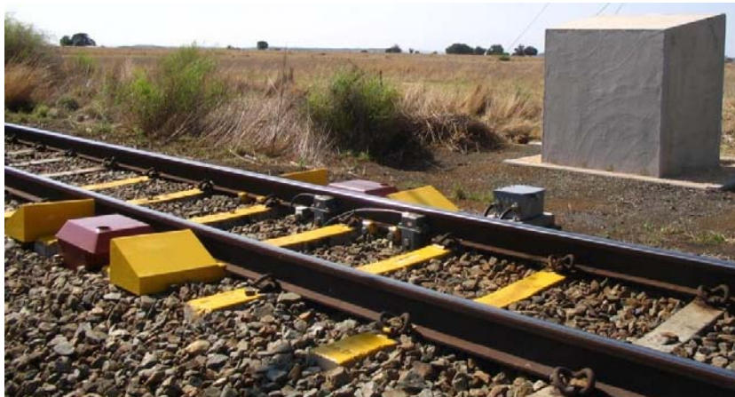
Слика 5.1. Стационарна мерна станица (извор: Predikto)
