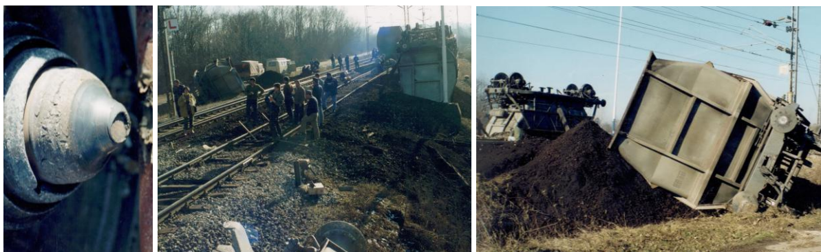
Слика 4.29. Исклизнуће узроковано отказом лежаја (Србија, 1995. године)
