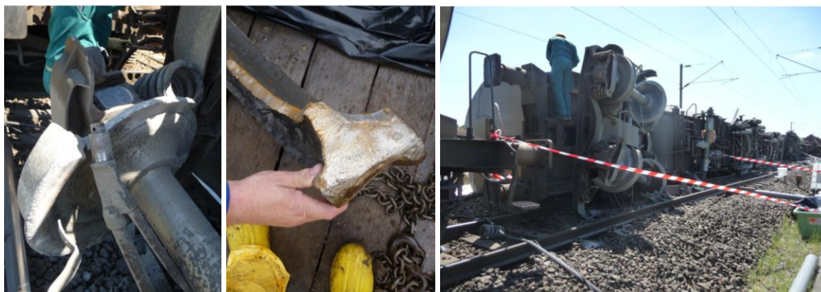
Слика 4.27. Исклизуће узроковано ломом точка (Француска, 2010. године)
