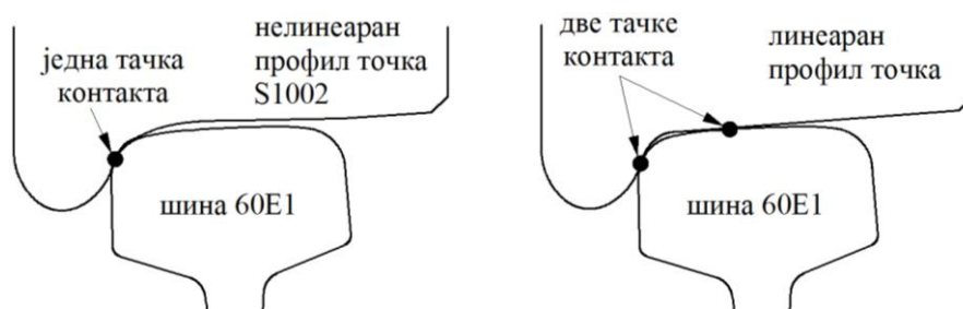
Слика 2.12. Контакт преко венца – једна и две тачке контакта
