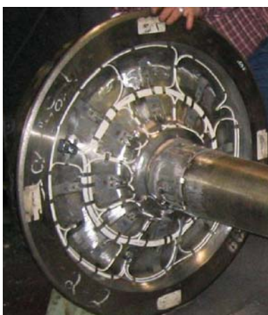
Слика 5.11. Мерни осовински склоп коришћен у раду [80]
