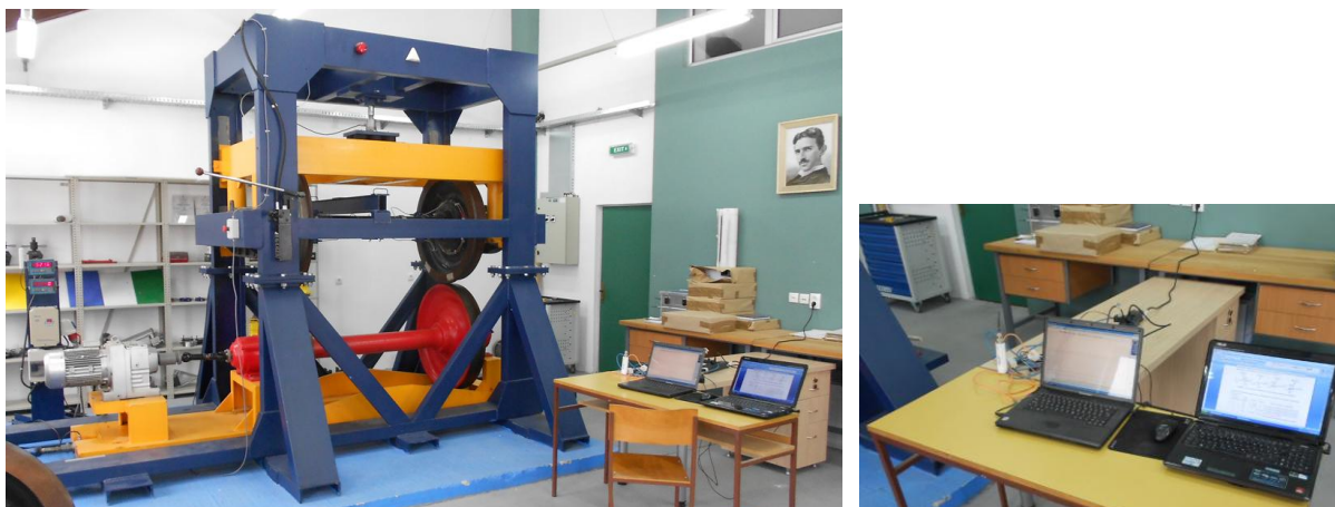
Слика 7.15. Детаљи са статичких испитивања мерног осовинског склопа
