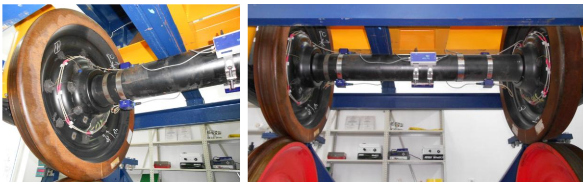
Слика 7.1. Мерни осовински склоп мерног система МЕРОСА коришћен у експерименталним испитивањима
