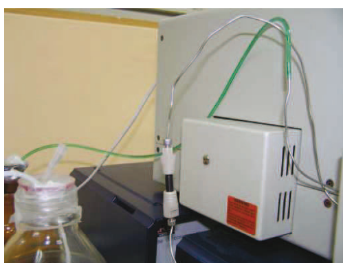
Slika 13. Bioanalitička kolona sa imobilizovanom AChE
