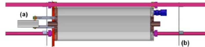
Slika 4.5: Šematski prikaz komore sa gasom: a) prvi RPA i b) zaštitna mreža koja onemogućava da se napon zamke prelije na zonu transporta pozitrona.
