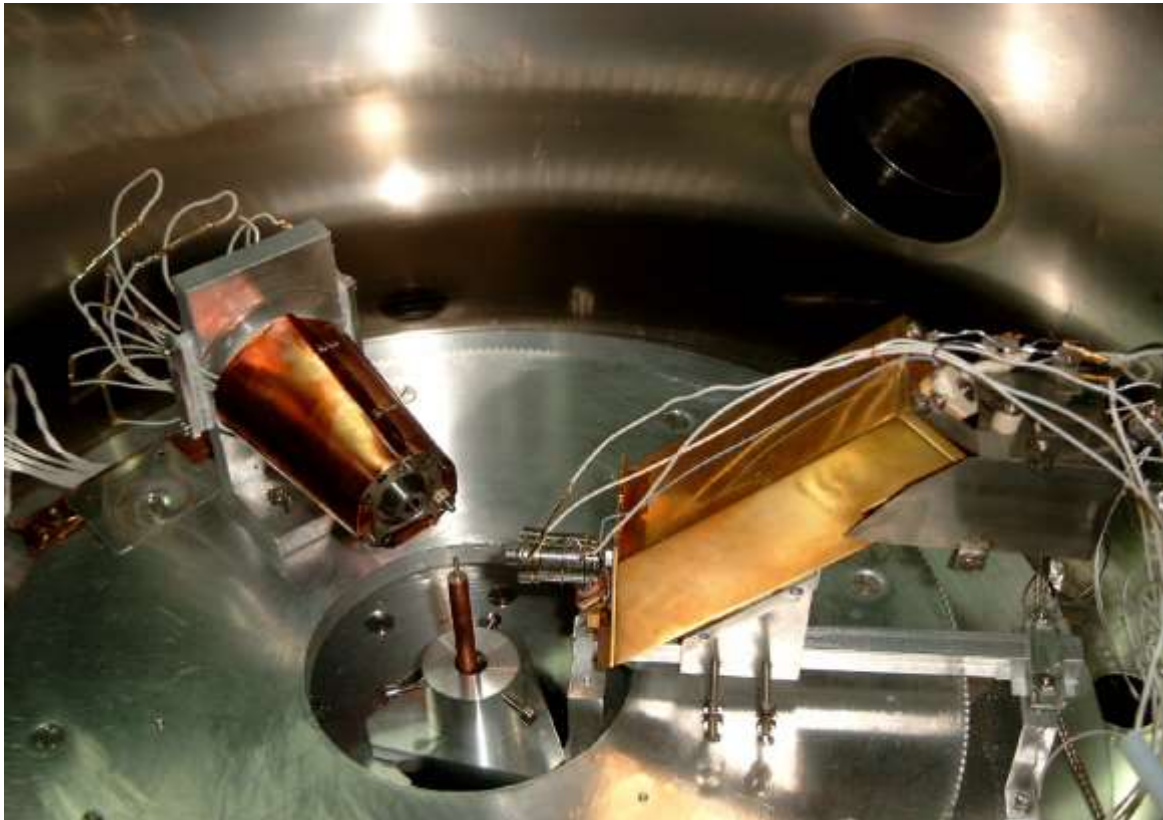
Slika 3.4. Unutrašnjost aparature UGRA [52]. Na slici vidimo elektronski top (levo, oklopljen bakarnim štitom), gasnu iglu (u sredini) i analizatorski sistem (desno).
