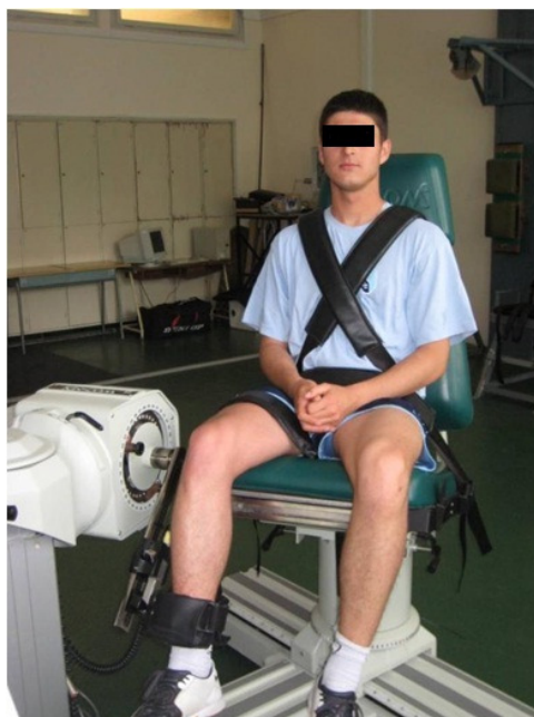
Slika 2. Položaj ispitanika prilikom izvođenja testova na izokinetičkom dinamometru (Kin Com 125AP, Chattex Corp., Chattanooga, Tennessee, USA)
