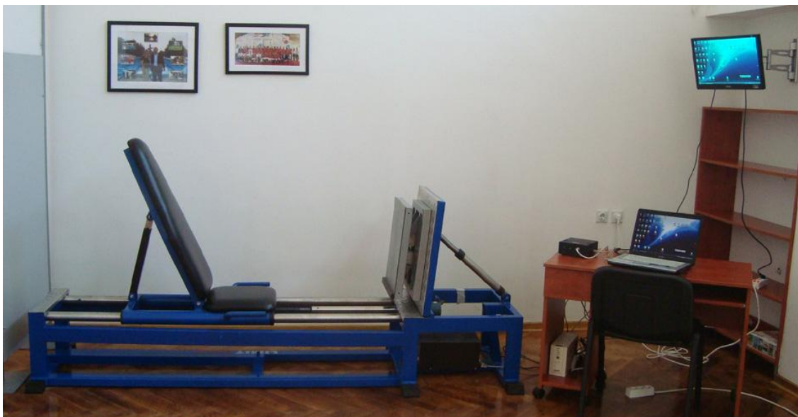
Слика 3. Апаратура за мерење максималне изометријске силе опружача ногу с припадајућом хардверско-софтверском опремом
