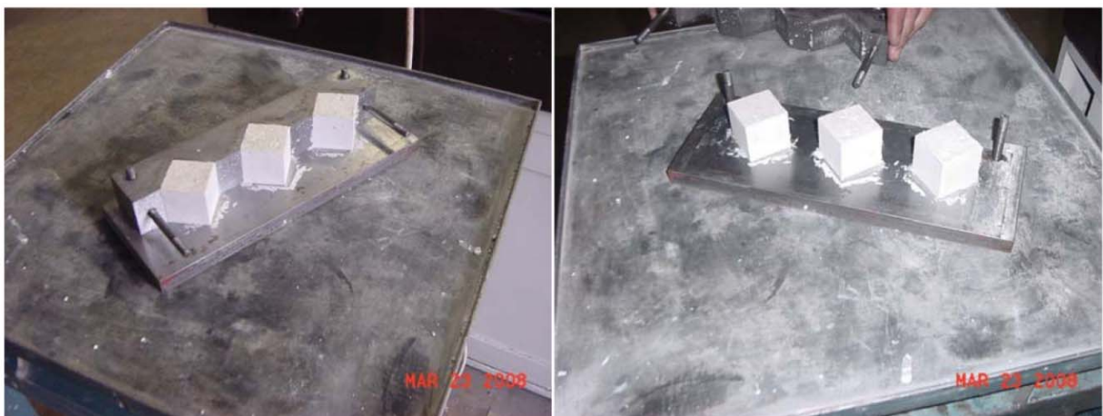
Slika 19. Priprema uzoraka niskocementnog betona
