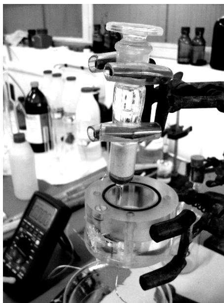
Slika 3.2. Ćelija za testiranje korozione stabilnosti kompaktnih elektroda i \text{Hg}/\text{Hg}_2\text{SO}_4 (4,4 M \text{H}_2\text{SO}_4 ) referentna elektroda
