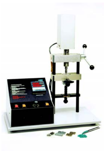
Slika 8.2.2 - Uređaj za dobijanje uzoraka sa PMMA matricom metodom injektovanja
