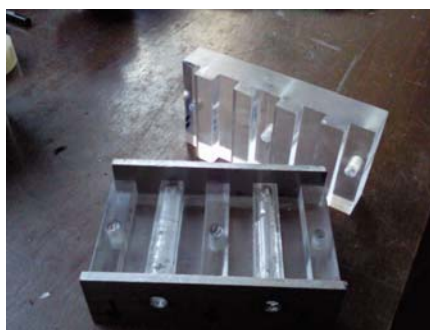
Slika 8.1.1 - Oprema za sintezu kompozita sa epoksi matricom metodom presovanja
