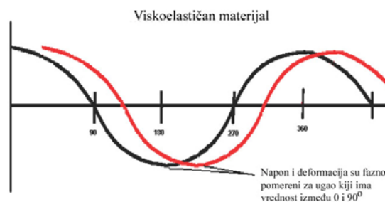
Slika 5.2.6 - Sinusoida napon/deformacija za viskoelastičan materijal
