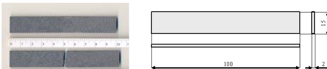
Slika 9.5.10 - Epruvete magnetnog kompozita Nd-Fe-B / epoksi za ispitivanje na savijanje
