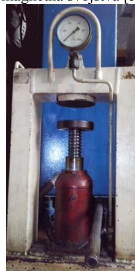
Slika 8.1.1 - Oprema za sintezu kompozita sa epoksi matricom metodom presovanja
