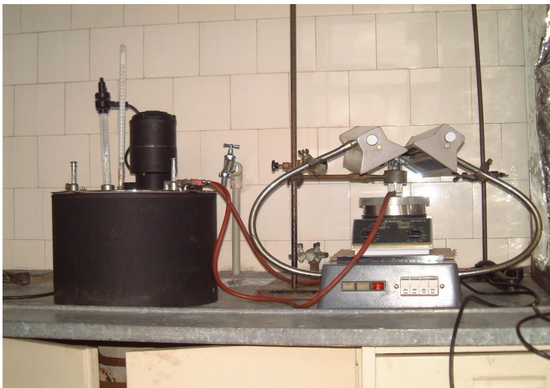
Slika 1. Aparatura za fotolizu i fotokatalizu pesticida na 254 nm i na 366 nm.
