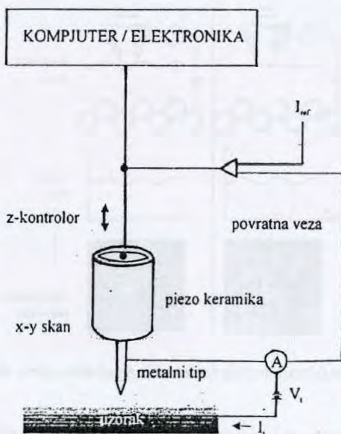
Slika 3.3. Shematski prikaz rada STM-a.
