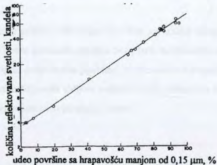
Slika 2.24. Veza između količine reflektovane svetlosti i udela površine sa hrapavošću manjom od 0,150 μm. 23
