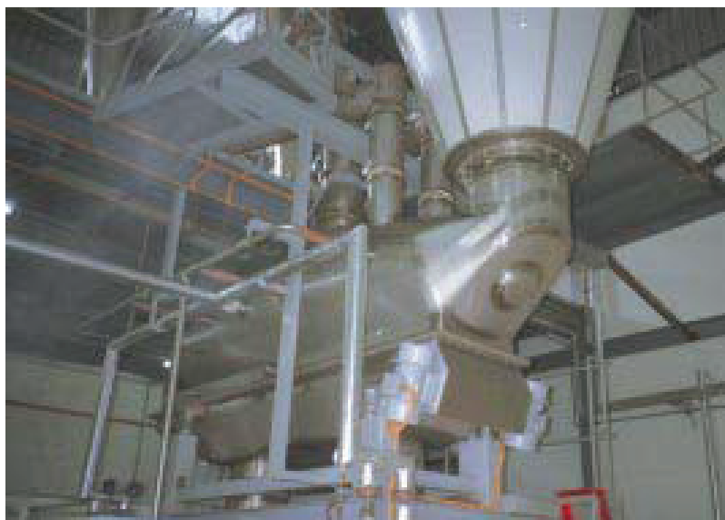
Slika 1.3. Prikaz koničnog dna sušnice sa raspršavanjem na koji se nastavlja sekundarna sušnica sa vibro-fluidizovanim slojem
