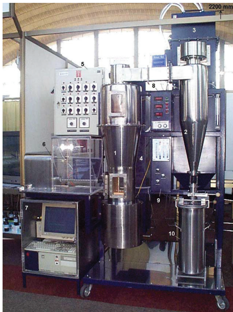
Slika 3.5. Mobilno poluindustrijsko demonstraciono postrojenje za sušenje suspenzija i pasta u fluidizovanom sloju inertnog materijala
