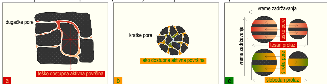
Slika 2.9. Efekat veličine čestice na transport reaktanata i proizvoda reakcije u porama katalizatora: a, b [52], c → povećanje vremena zadržavanja molekula TAG u porama katalizatora (Synetix).
