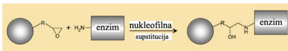
Slika 3.5. Šematski prikaz imobilizacije enzima na Sepabeads EC-EP nosač [104]
