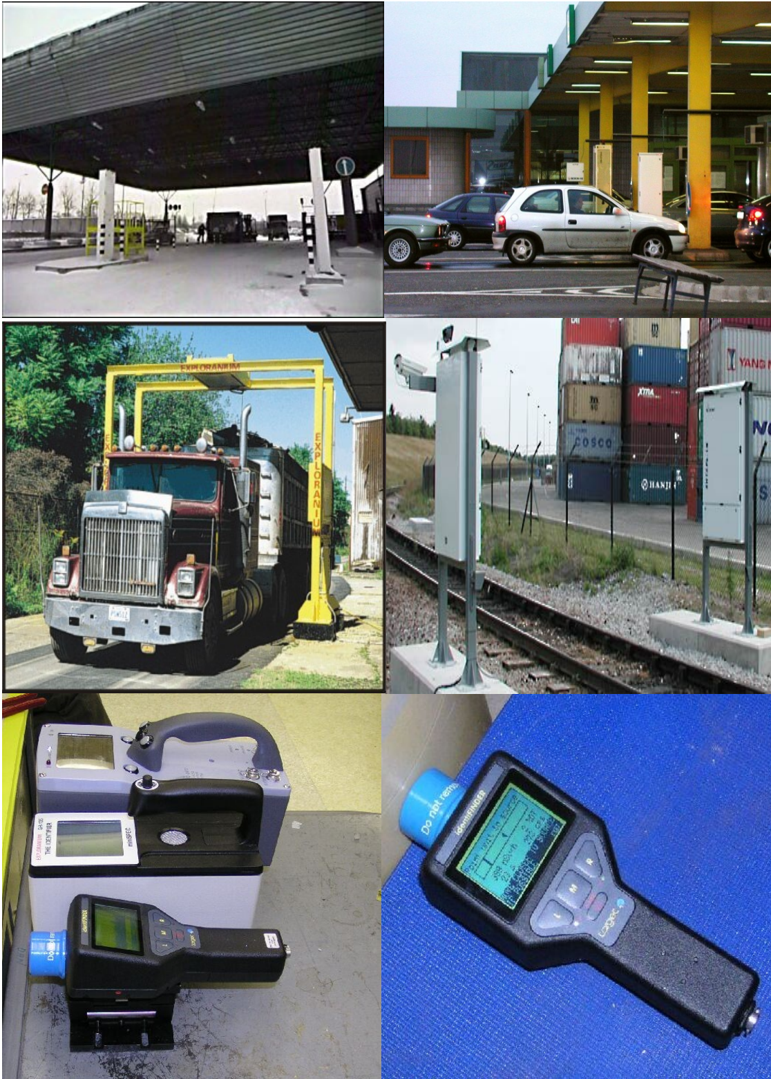
Прилог 5: Стационарни и мобилни детектори за откривање радиоактивног материјала на граничним прелазима (Извор: IAEA: Introduction to Instruments Designed to Monitor, Detect and Identify Nuclear and Radioactive Materials at Borders, October 2008.)
