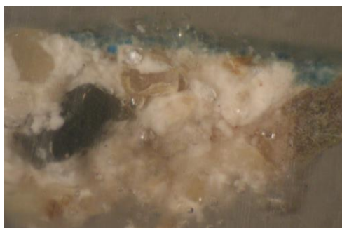
Сл. 89. Оптичка микроскопија у одбијеном светлу. Изглед попречног пресека узорка под стереомикроскопом у увећању 126X.
