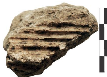
Сл.9. Полеђина малтера са веома танким отисцима прућа или трске.
