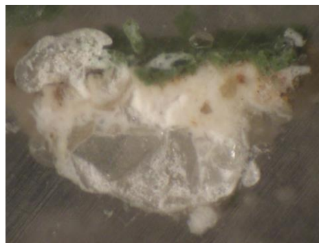
Сл. 91. Оптичка микроскопија у одбијеном светлу. Изглед попречног пресека узорка под стереомикроскопом у увећању 90X.
