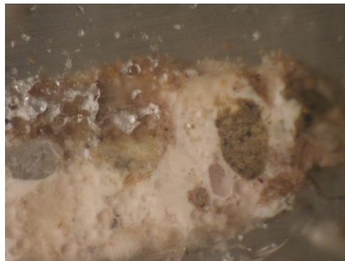
Сл. 88. Оптичка микроскопија у одбијеном светлу. Изглед попречног пресека узорка под стереомикроскопом у увећању 126X.
