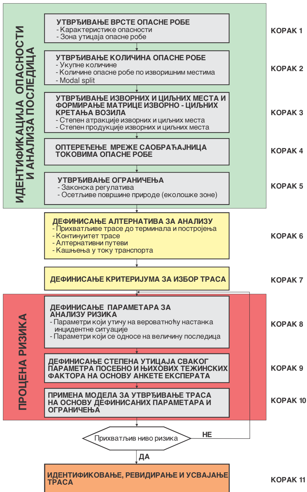
Слика 4.1. Приказ методологије за избор траса за кретање возила која транспортују опасну робу са аспекта управљања ризицом
