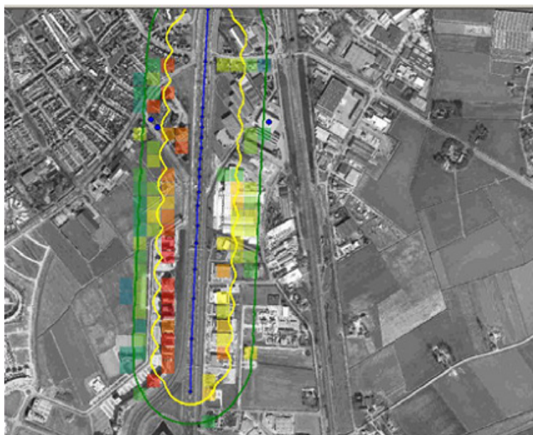
Слика 4.2. Зона утицаја опасне робе код покретних извора опасне робе (Wiersma et al., 2006)
