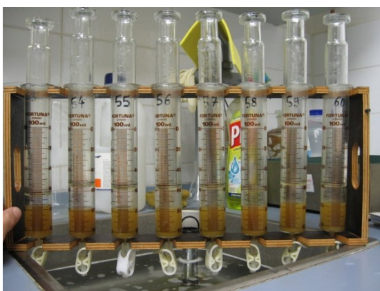
Slika 4-31. Siringe nakon inkubacije, sa leva na desno: slepa proba, standardno seno, različiti uzorci
