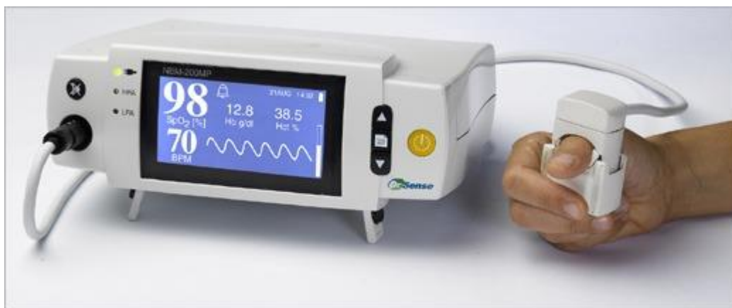
Слика 17. Неинвазивни сензор за мерење концентрације глукозе заснован на методи окузионе спектроскопије NBM 200 MP, OrSense Ltd. [35]
