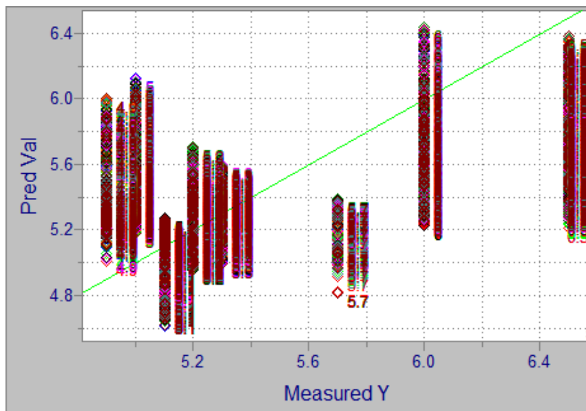
Слика 150. Корелација између измерених вредности глукозе (Measured Y) и вредности глукозе одређене према развијеном моделу (Pred Val) за хиперспектралне слике коже и крвног судау SWIR региону
