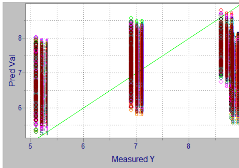
Слика 160. Корелација између измерених вредности глукозе (Measured Y) и вредности глукозе одређене према развијеном моделу (Pred Val) за хиперспектралне сликекоже и крвног суда у SWIR региону
