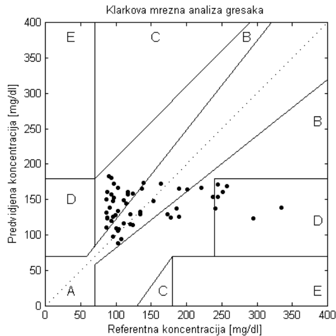
Слика 132. Кларкова мрежна анализа грешака за предвиђене вредности концентрације глукозе за методу OMIS - B53 при чему су коришћени спектри крвног суда
