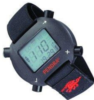
Слика 19. Pendra, уређај за неинвазивно мерење глукозе на принципу биоимпедансне спектроскопије [68]
