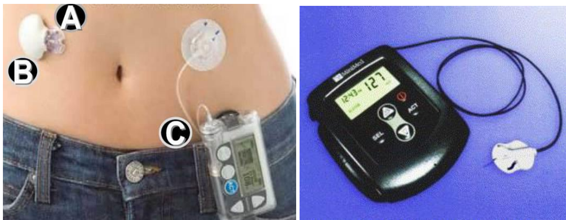
Слика 15. CGMS System Gold минимално-инвазиван глукометар компаније Medtronic MiniMed. Сензор се поставља под кожу у пределу абдомена и врши праћење нивоа глукозе у интерстицијској течности непрекидно и до 72 часа: А-сензор, Б-сензор инсертер, Ц-монитор који је у вези са рачунаром [30]
