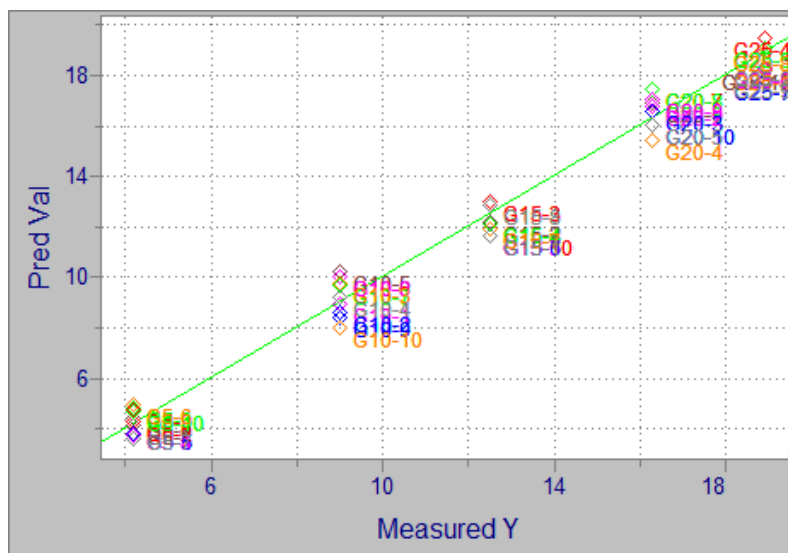
Слика 108. Корелација између измерених вредности глукозе (Measured Y) и вредности глукозе одређене према развијеном моделу (Pred Val) за NIR спектре водених раствора глукозе
