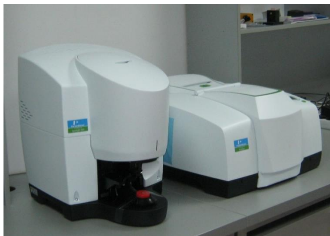
Слика 65. Perkin Elmer FTIR Spotlight 400, Нанолаб, Машински факултет у Београду
