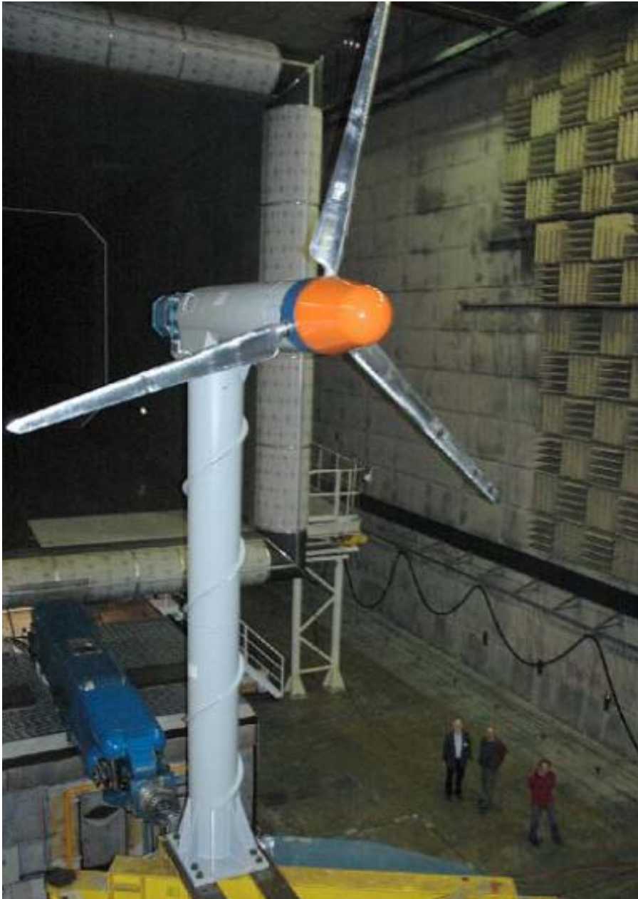
Слика 4.2. MEXICO експеримент у аеротунелу DNW-а [101]
