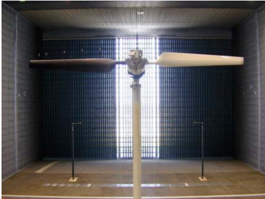
Слика 4.1 Ветротурбина NREL Phase VI у NASA Ames аеротунелу [99]
