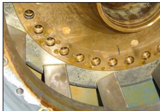
Слика 2.3. Изглед статорских лопатица физичког модела
