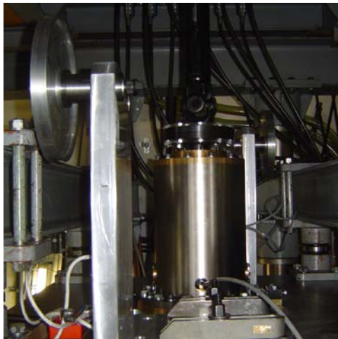
Слика 3.11. Турбински лежај са уграђеним мерилом момента
