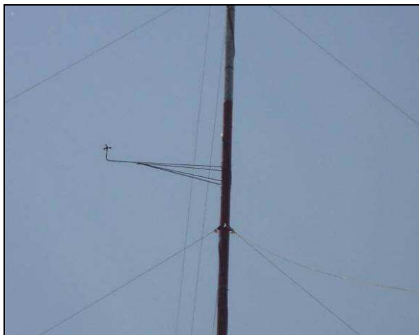
Slika 3: Merna oprema na visini 40 m
