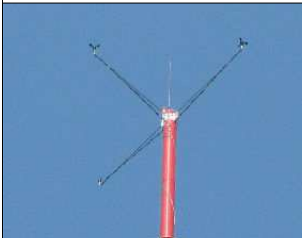
Slika 1: Merna oprema na visini 60 m
