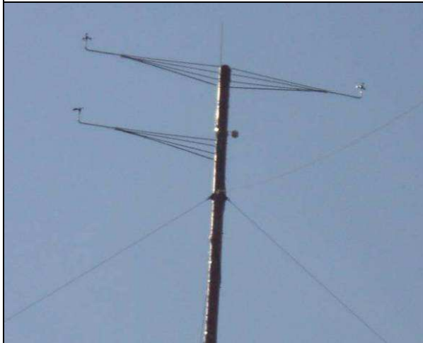
Slika 1: Merna oprema na visini 58 - 60 m
