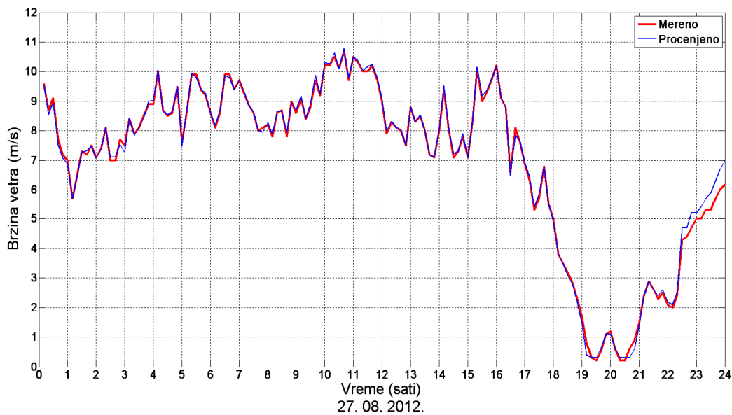
Slika 4.35: Merena i estimirana brzina vetra na visini 60 m u toku analiziranog dana
