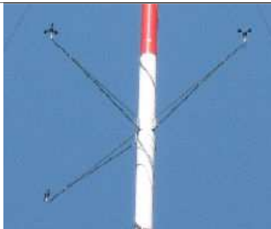
Slika 2: Merna oprema na visini 50 m
