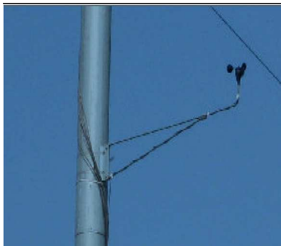
Slika 4: Merna oprema na visini 10 m
