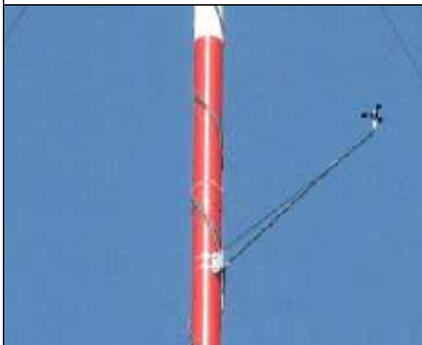
Slika 3: Merna oprema na visini 40 m
