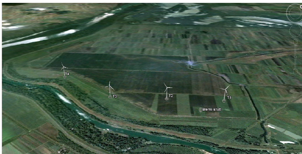
Slika 5.6: Mikrolokacija vetroelektrane ( 4 \times Enercon E44, 500 kW) na satelitskom ( Google Earth ) snimku terena
