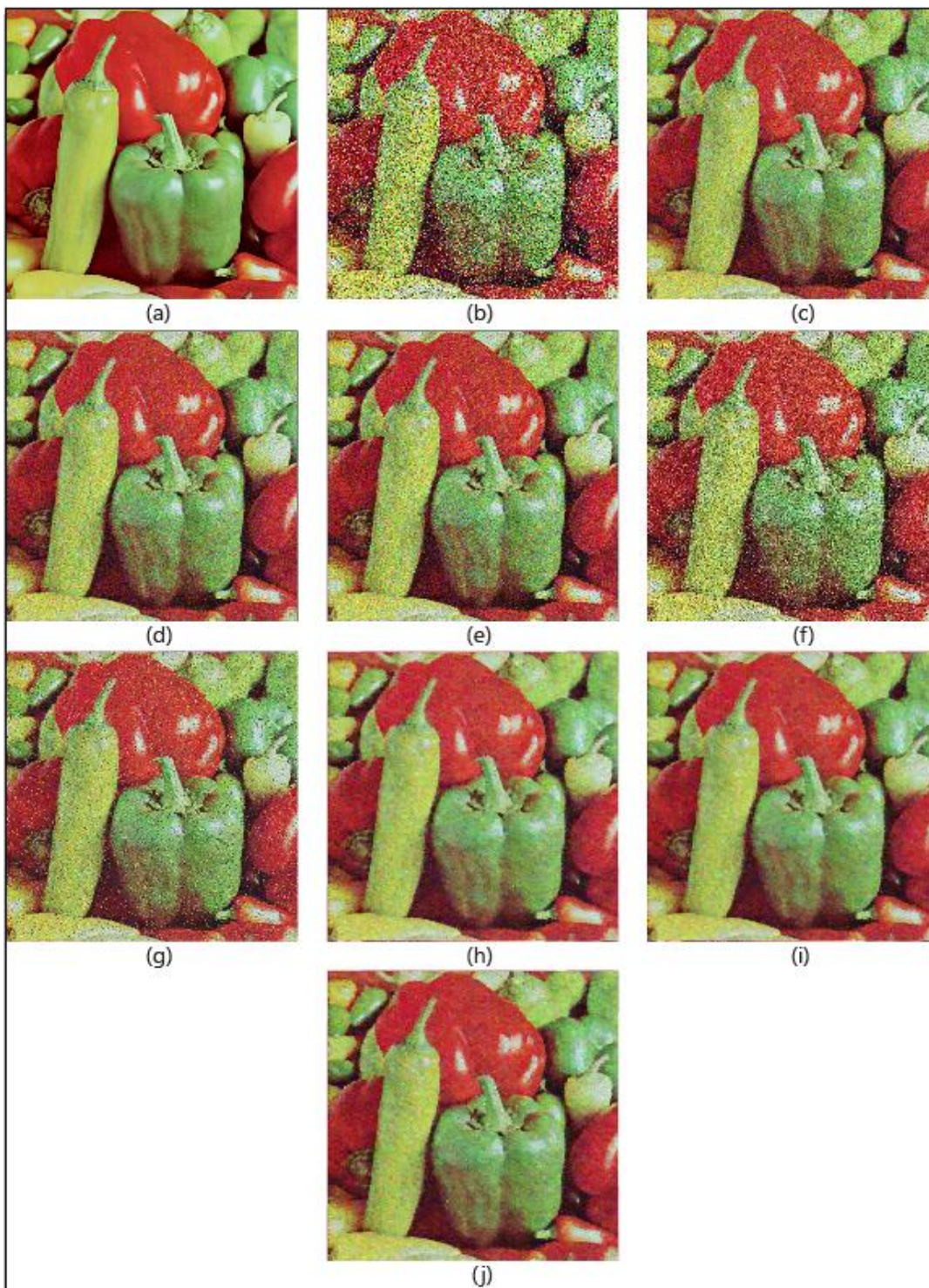
Slika 13. Rezultati poređenih filtera za otklanjanje višekanalnog mešovito šuma primenjenih na sliku "Peppers" (512x512): (a) slika bez šuma, (b) ista slika na koju je primenjen mešoviti šum koji se sastoji od salt-and-pepper šuma gustine 0.05 i AGCN šuma varijanse 0.1 (PNSR=14.1 dB), (c) rezultat otklanjanja šuma pomoću MMF (PSNR=19.89 dB), (d) rezultat otklanjanja šuma
