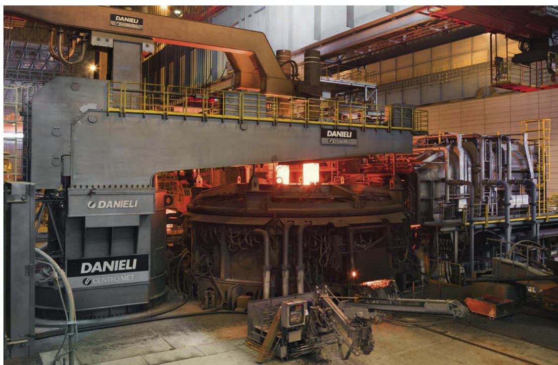
Слика 2.9 Пећ за једносмјерну струју, капацитета 420 t, у постројењу компаније Tokyo Steel. © Danieli.
