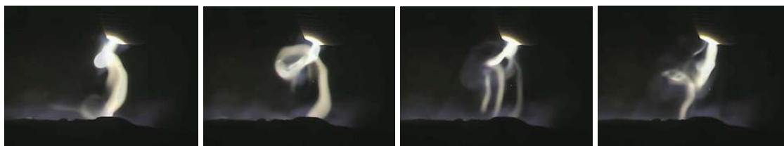
Слика 3.7. Четири узастопна фрејма при струји лука једнакој 1000 A и дужини лука једнакој 10 cm.
