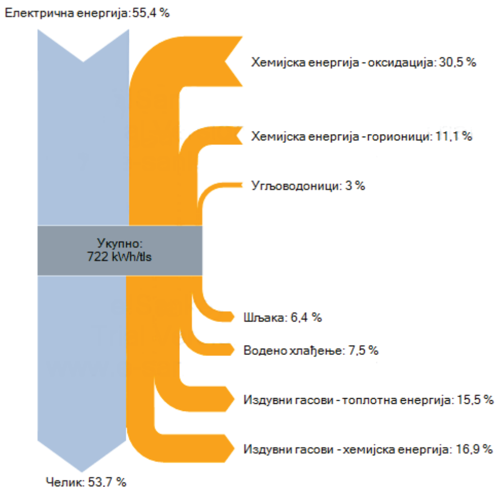
Слика 2.16. Енергетски биланс модерне електролучне пећи за наизмјеничну струју, компаније Tenova.
