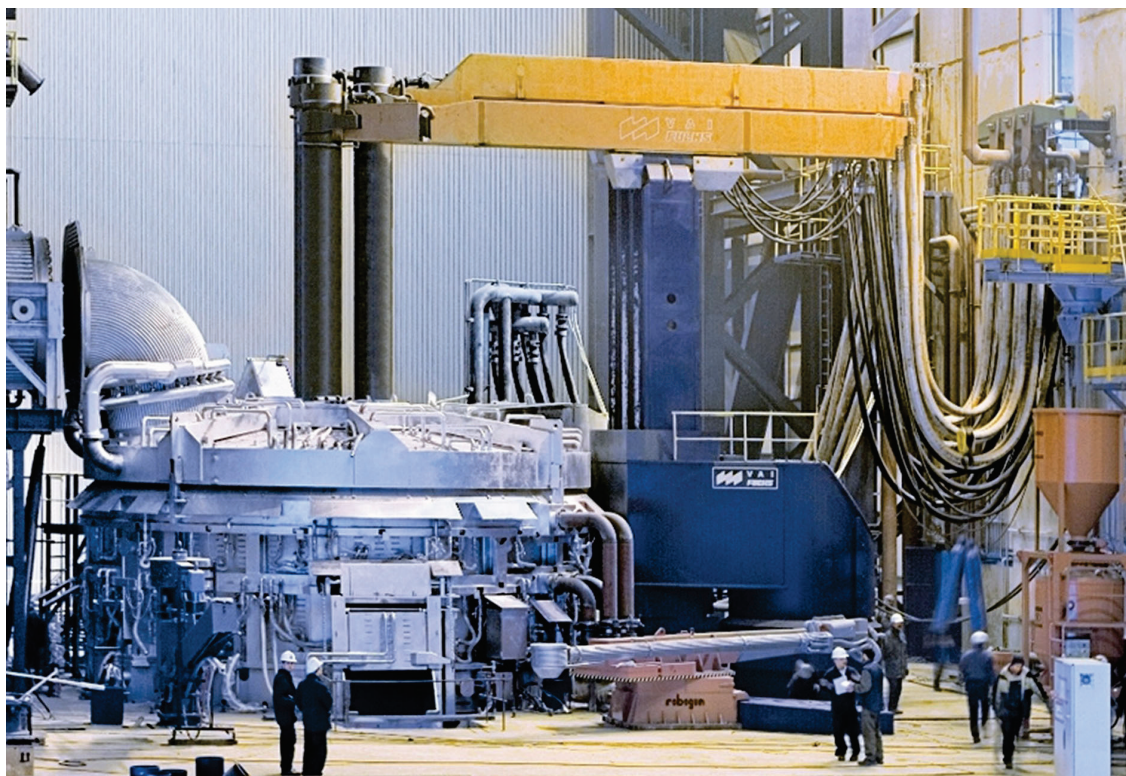
Слика 2.8 Пећ за наизмјеничну струју, капацитета 320 t у постројењу компаније Çolakoğlu Metalurji A.S. © Siemens press picture.
