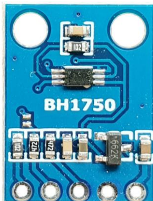
Слика 7.14 BH1750 сензор интензитета дневне светлости
