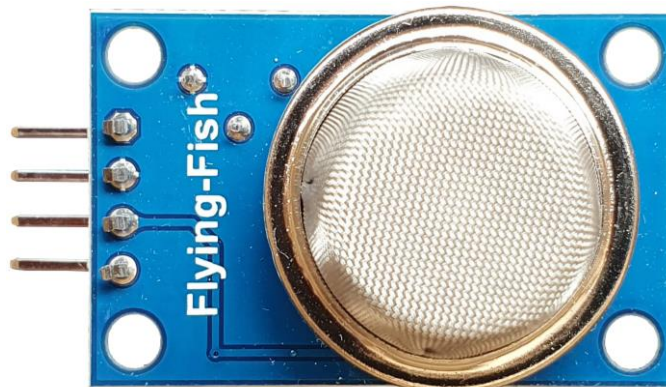
Слика 7.13 Сензор MQ135 за детектовање присутности гасова и мерења ppm вредности
