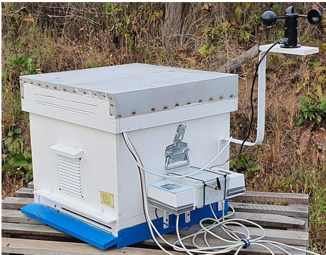
Слика 7.2 Експериментална поставка кошнице са сензорском електроником
