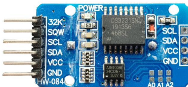
Слика 7.8 RTC 3231 Real time clock модул
