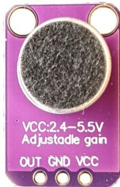
Слика 7.19 MAX4466 звучни сензор
