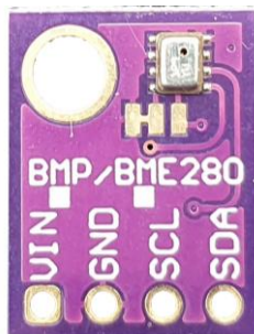
Слика 7.17 BME280 сензор
