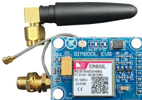
Слика 7.9 SIM800L GPRS GSM модул
