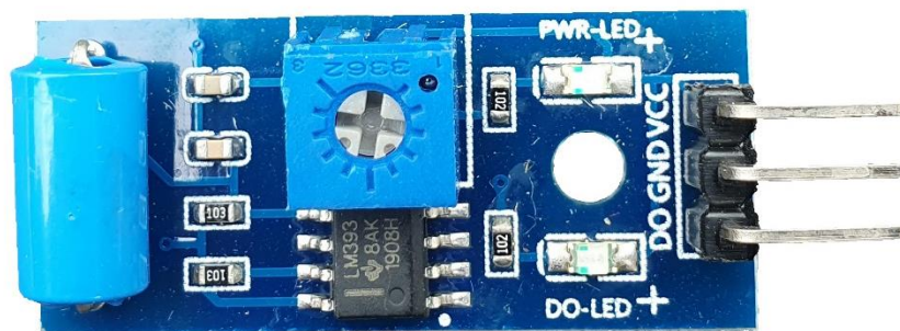
Слика 7.11. Сензор вибрација SW420
