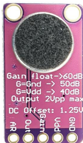
Слика 7.20 MAX9814 звучни сензор
