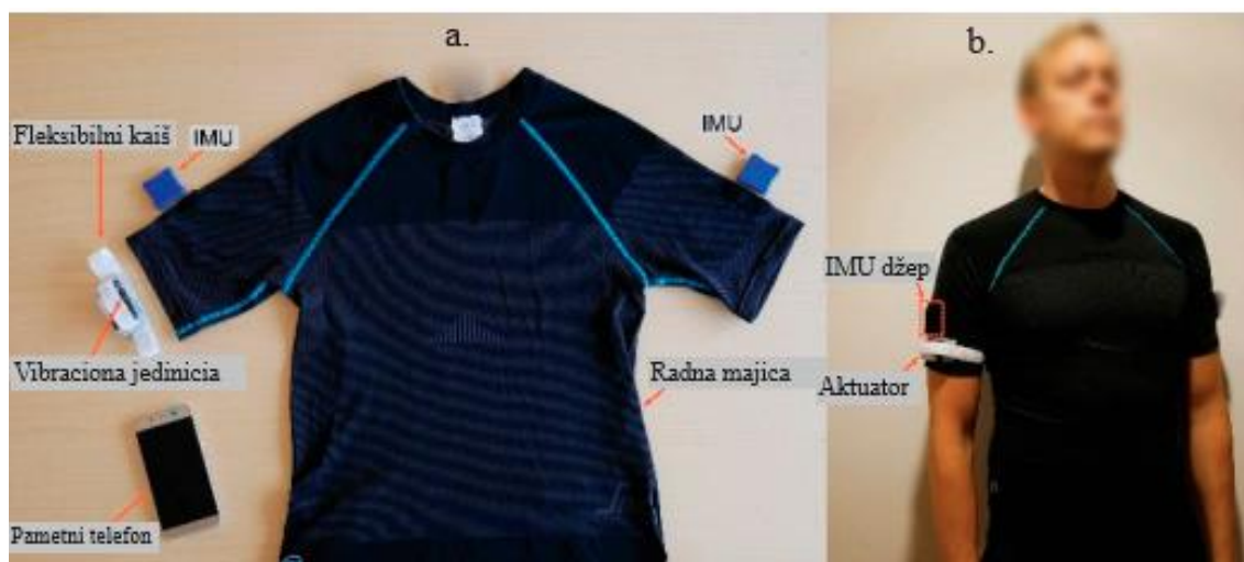
Slika 16. (a.) Sistem pametne radne odeće, (b.) postavljen na ljudsko telo sa dve IMU za snimanje radnih položaja nadlaktica i za obezbeđivanje haptičkog signala povratne informacije o dominantnoj ruci [79].
