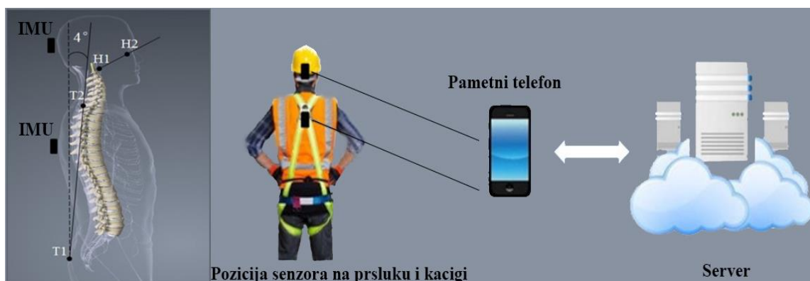
Slika 5. Ian i sar. [64] Pozicije senzora na zaštitnom šlemu i radnom prsluku.
