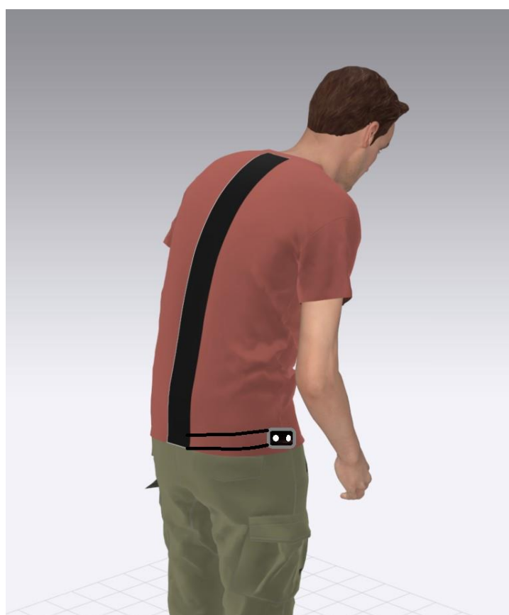
Slika 28. Pozicija džepa sa kućištem mikrokontrolera
