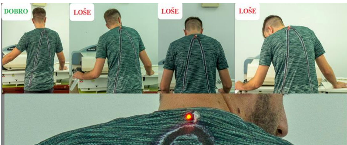
Slika 35. Senzor detektuje loš položaj tela
