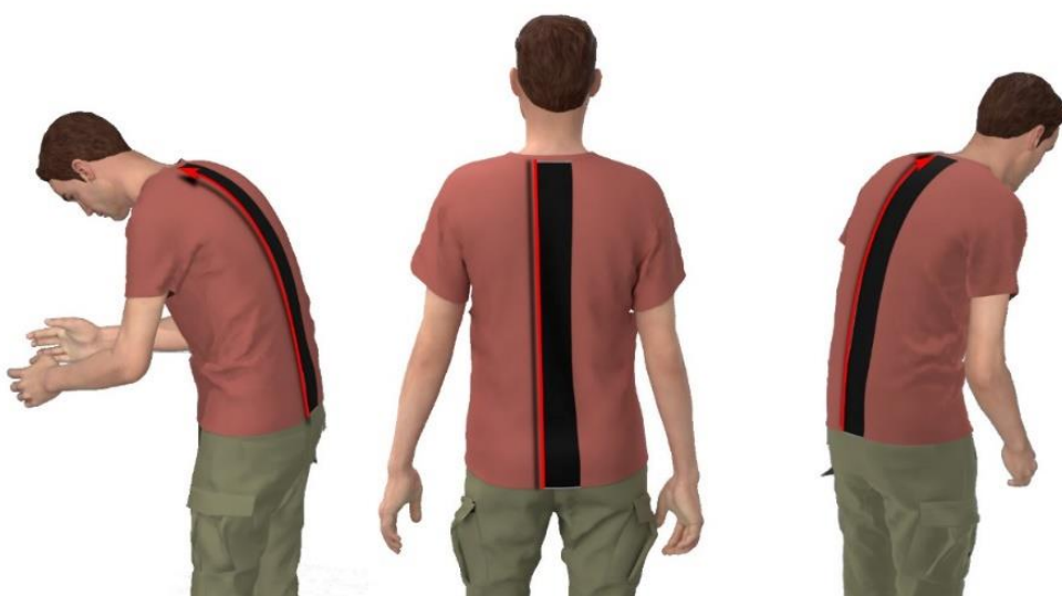
Slika 20. Pozicija senzora na radnoj majici i detekcija devijacije položaja leđa
