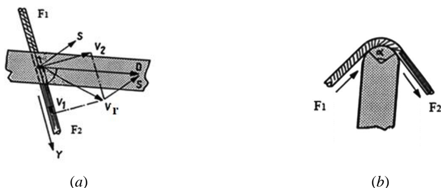
Slika 1.13. Međusobno dejstvo sila između diska i pređe u procesu teksturiranja
