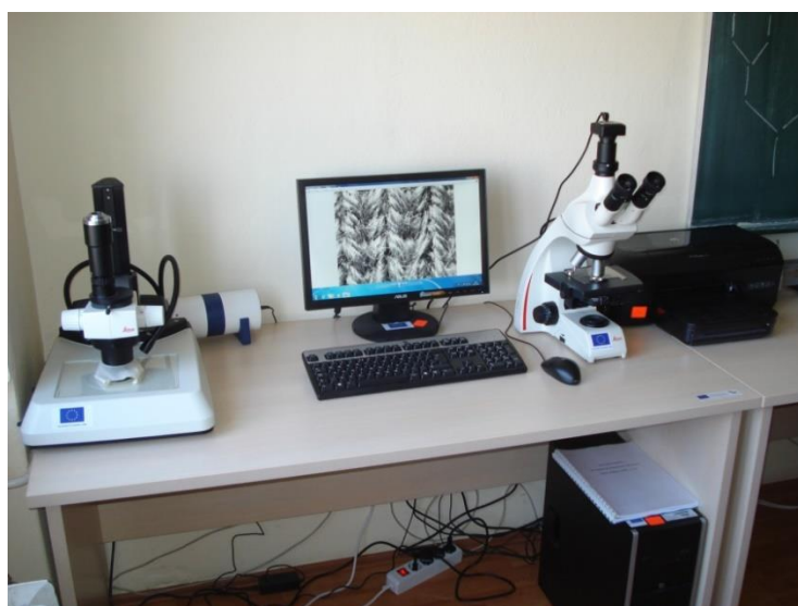
Slika 2.10. Mikroskop Leica sa softverom Video Analyser 2000
