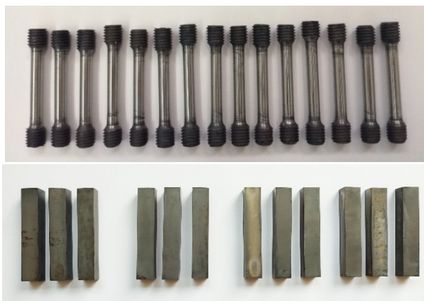
Slika 2.6 Prikaz epruveta nakon termičkog tretmana za ispitivanje zatezanjem i energije udara
