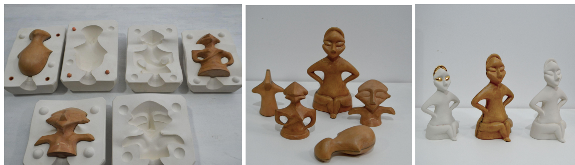
Слика 22 – лево: модели рађени у глини у гипсаним калупима; средина: модели од глине; десно: модел, осушени одливак и глазиран и позлаћена фигурина 2021
