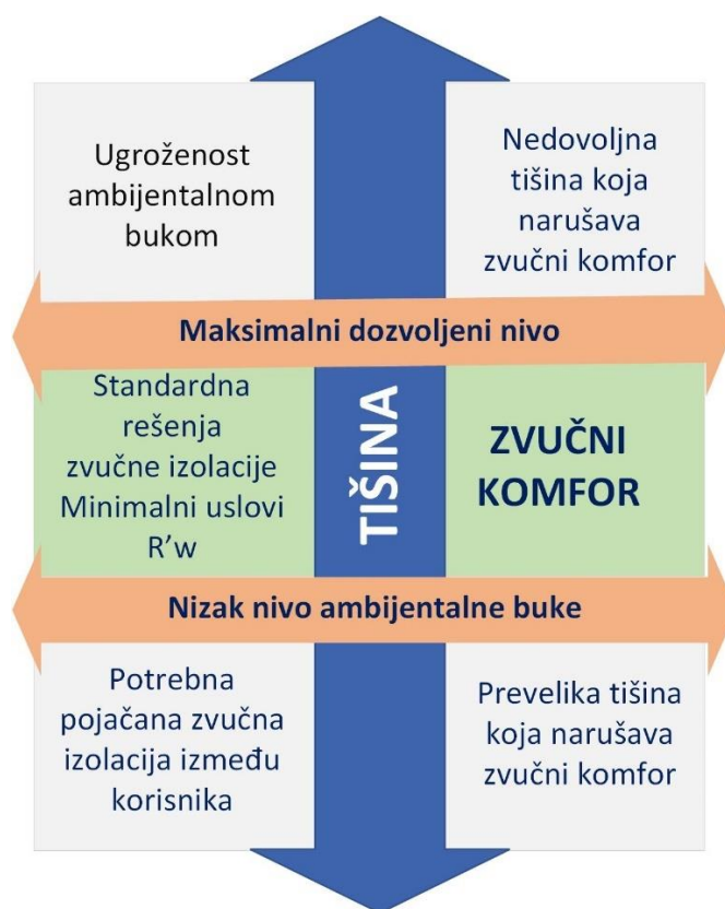
Slika 7.1 Šematska ilustracija problema sa prekomerno niskim i prekomerno visokim nivoom ambijentalne buke u prostorijama i principima njihovog prevazilaženja
