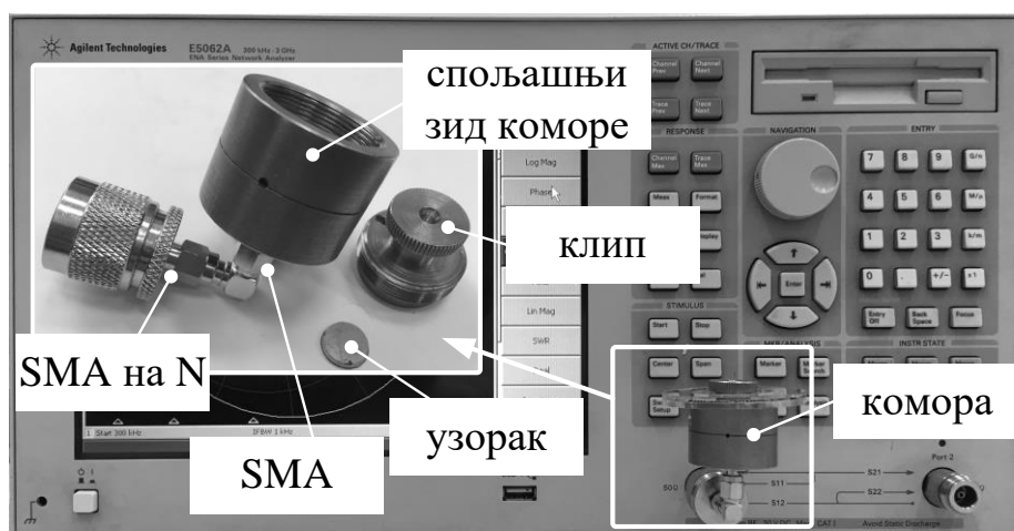
Слика 4.18. Фотографија анализатора мрежа на који је повезана комора. Фотографија расклопљене коморе уметнута је на фотографију. [66]
