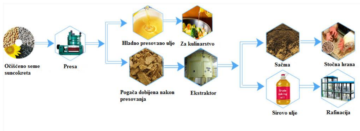
Slika II.9. Konvencionalna prerada suncokreta u cilju dobijanja ulja (prilagođeno sa https://www.seedoilpress.com/oil-production-plant/sunflower-oil-production-line.html )
