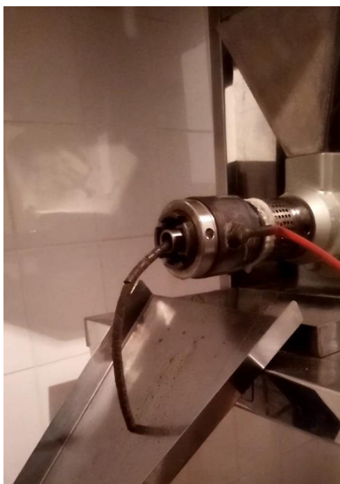
Slika III.5. Pužna presa korišćena u proizvodnji hladno presovanih ulja semena suncokreta
